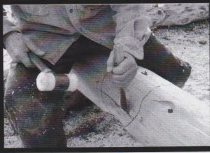
Inciser à la gouge et au ciseau droit sur AD et BC...
