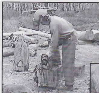
Ne jamais poser la tronçonneuse à terre
