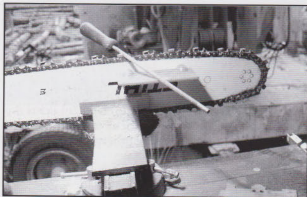
Le guide lime magnétique (Kox)
