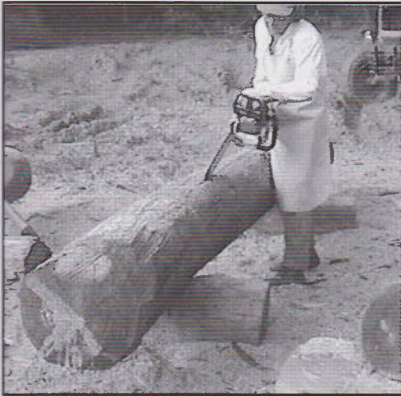
Pour la découpe des gorges, une tronçonneuse plus puissante
