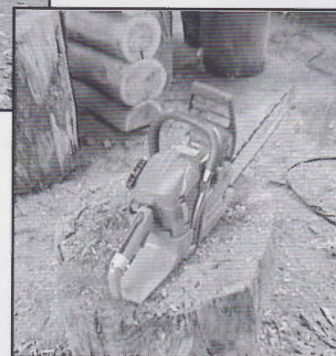
Ne jamais poser la tronçonneuse à terre
