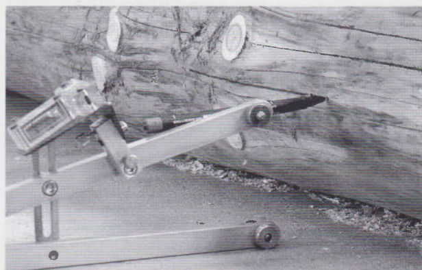
(7) Tracer un encastrement de plancher
