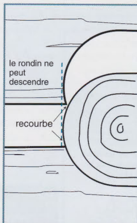
1. le rondin B ne peut s'encastre dans le rondin A
