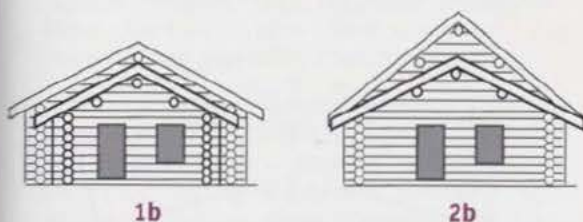
128 Agrandissement en imbriquant les volumes par le pignon : avec pentes de toit semblables 1b, ou différentes 2b.
