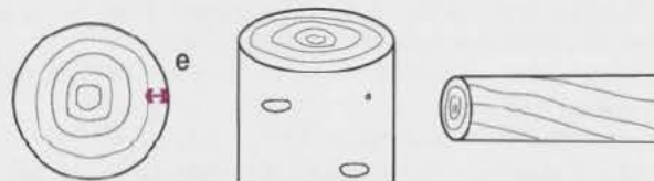
a largeur des cernes b diamètre des nœuds c pente du fil
