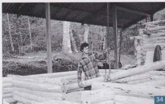
Un palan à chaîne ou électrique roulant sur une poutre
