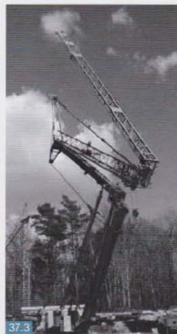
Les grues à montage rapide modernes sont équipées de vérins hydrauliques facilitant l'opération de montage et démontage.
