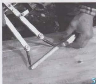
Régler l'ouverture du compas.
