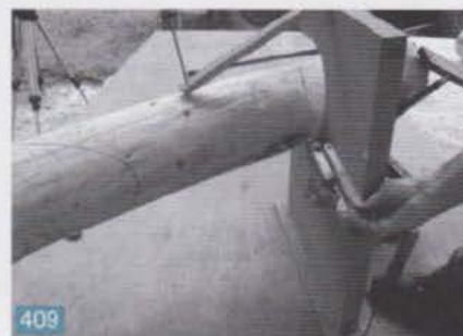
Traçage des embrèvements avec la guillotine et le trusquin.
