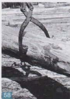
58 Attention ! les crochets peuvent ripper
