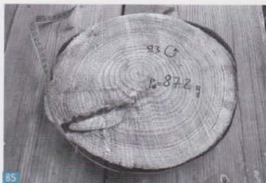
85 Prélever une rondelle peu épaisse (1 cm d'épaisseur environ) en évitant de la prendre en bout du fût.
