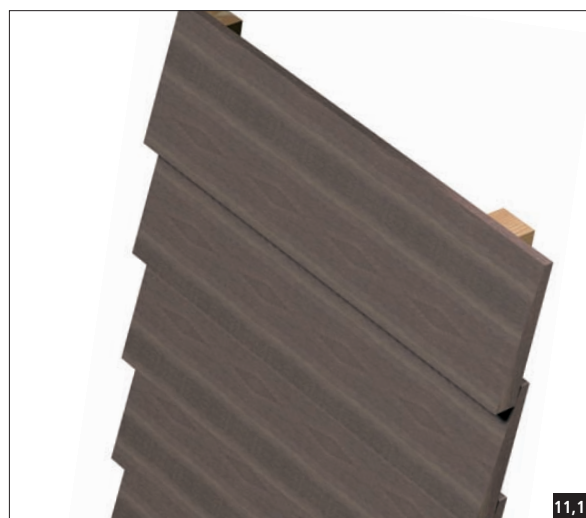
Fig. 11,10 Profils de lames à feuillure.
