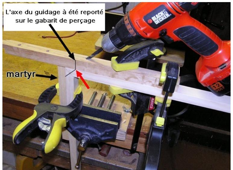
Selon la photo ci-dessus, à l'aide d'une équerre à 45°, positionner l'emplacement du tourillon en reportant le milieu de l'assemblage. Puis suivant ce tracé, installer le gabarit de perçage et le maintenir fermement à l'aide de serres joint. Ne pas oublier de placer un martyr
