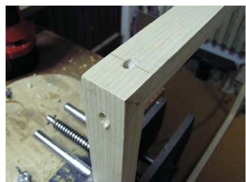
Percer au travers du gabarit de perçage, ce dernier guidant parfaitement la mèche jusqu'à atteindre le martyr.
