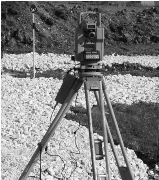
Fig. 3 Théodolite sur son trépied, et prisme en arrière-plan
