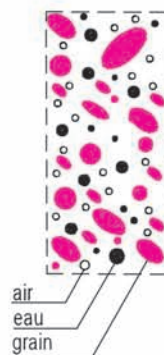
Fig. 27a : Structure du sol argileux
