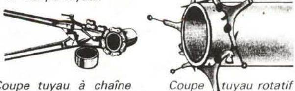
Coupe tuyau à chaîne manuel ou hydraulique
