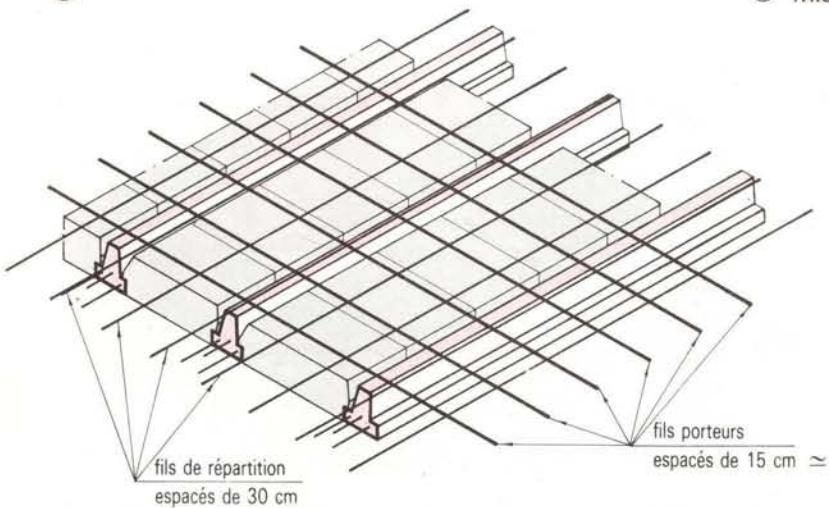
⑩ Armature d'une partie courante de dalle de compression
