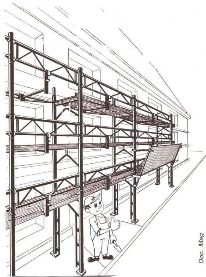
④ Échafaudage tubulaire à portiques préfabriqué sans raccords. Montage rapide par emboîtement
