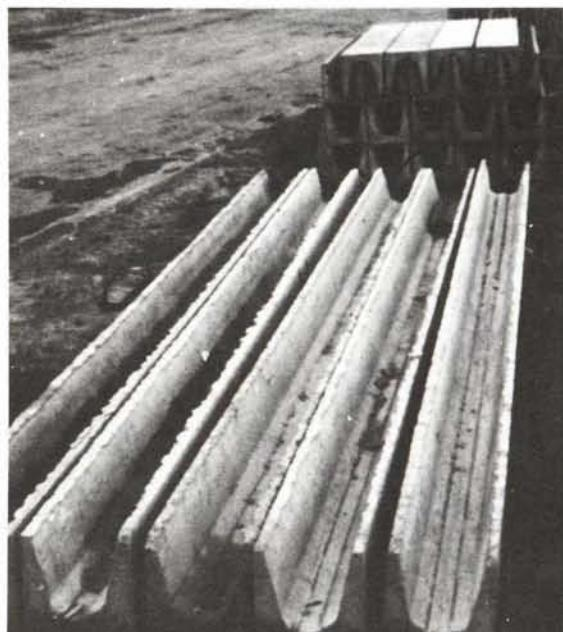
㉙ Bloc en U en béton moulé pour linteaux
