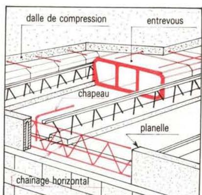
⑯ Détail d'un plancher avec le chainage horizontal
