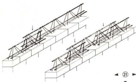
a) Recouvrement par emboîtement des profils
