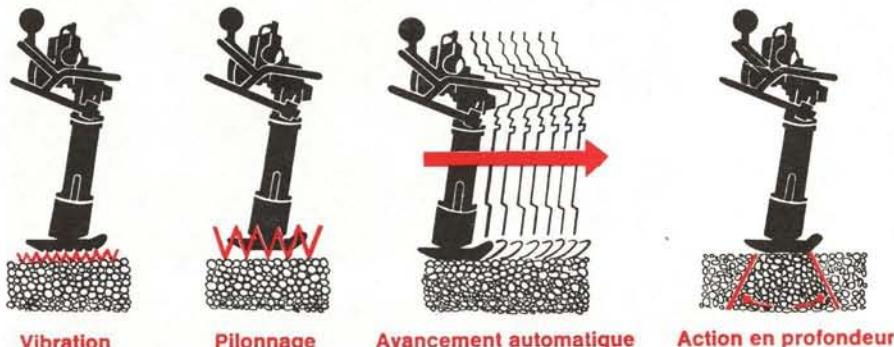
⑫ Compactage par pilonneuses vibrantes
