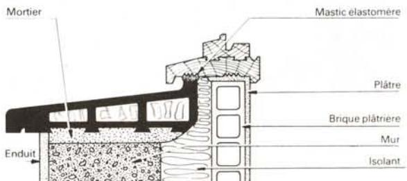
㉒ Mur avec isolant intérieur
