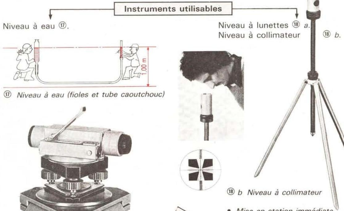
⑯ Niveau à eau (fioles et tube caoutchouc)
