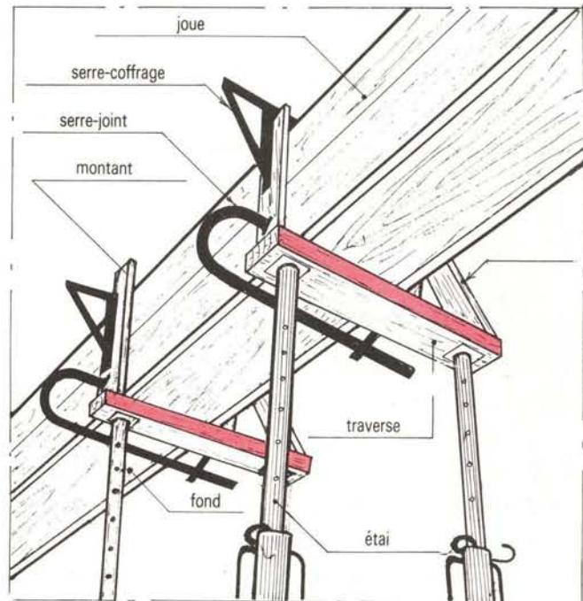
⑮ Coffrage d'une poutre par utilisation de raidisseurs transversaux (traverses) avec double file d'étais
