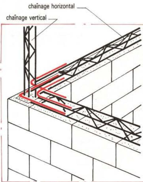
⑯ Trois équerres  $\varnothing 8$  disposées dans l'angle
