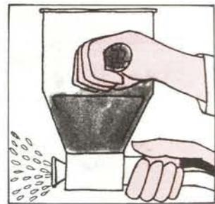
Pot de projection du mortier sous pression d'air
