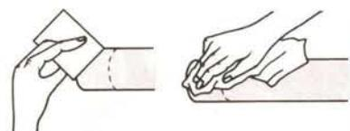
a) Dépolissage b) Nettoyage (toile émeri)
