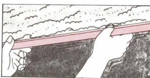
⑭ Dressement du mortier projeté à la règle et obtention d'une surface rugueuse
