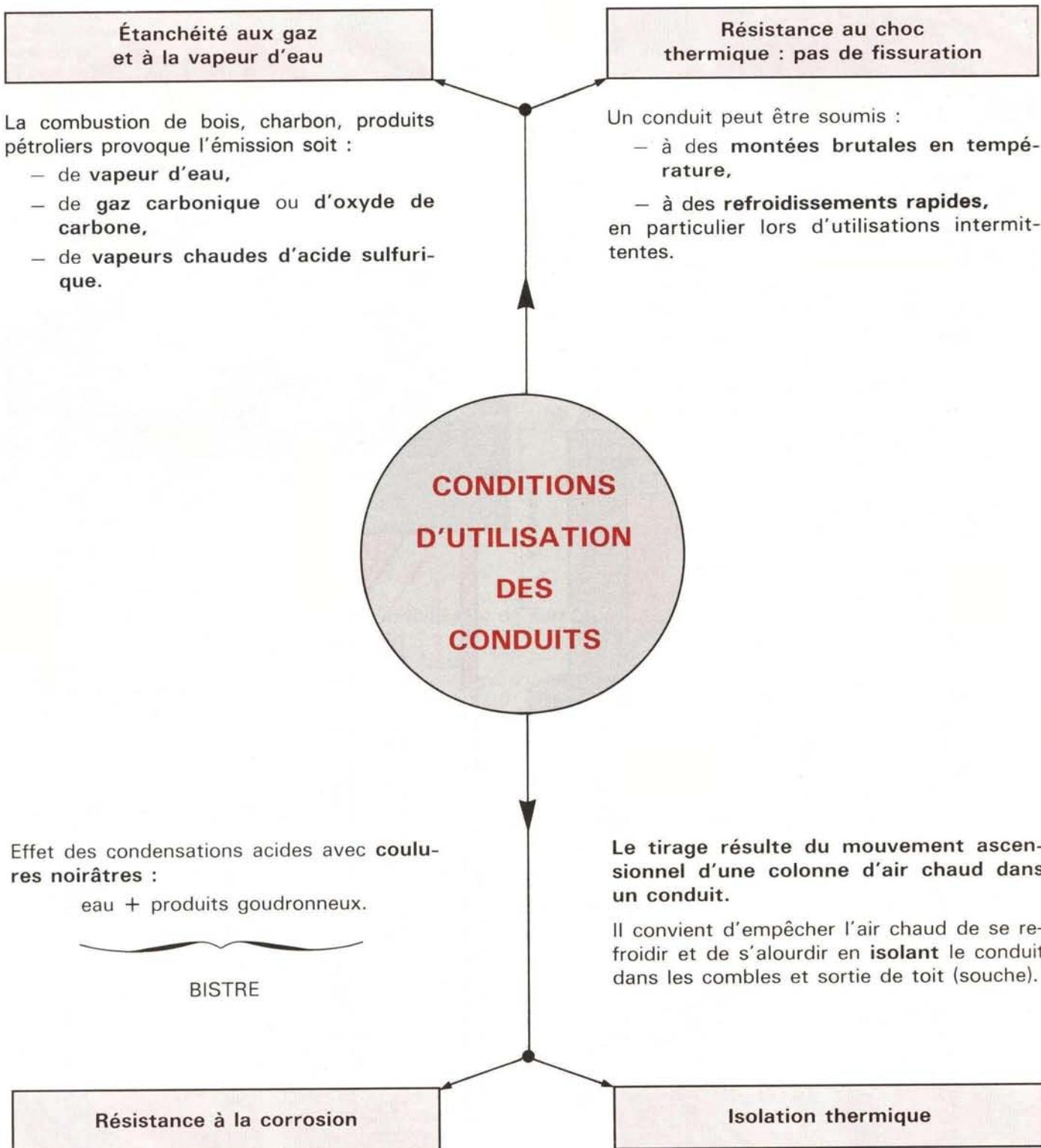
**NOTA :** La résistance à l'écrasement doit être  $\geq 10 \text{ MPa}$ , c'est la condition requise pour assurer l'auto-portance du conduit.
