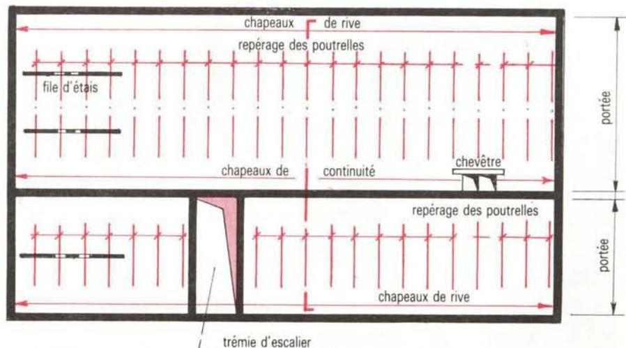
⑳ Schéma de principe d'un plan de pose
