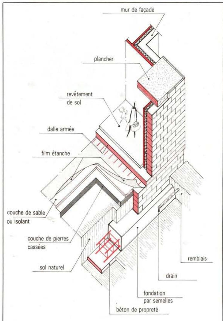
⑱ Maçonnerie en béton armé (détails)
