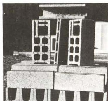
⑪ Blocs pour linteaux (planelle et blocs en U). Blocs d'angle pour chaînage vertical.
