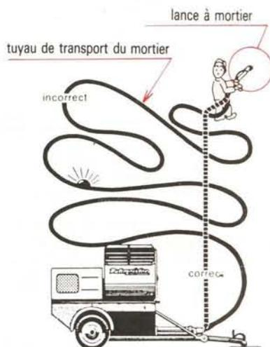
⑦ Schéma de principe d'utilisation d'une pompe à mortier
