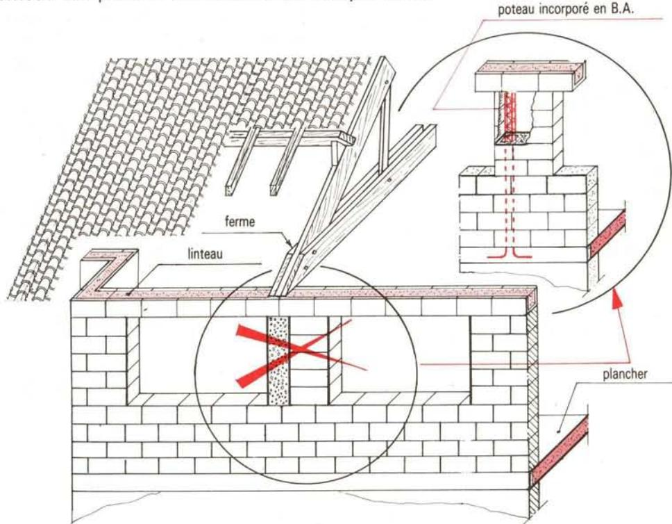
②⁹ Linteaux et ferme de charpente traditionnelle prenant appui sur le trumeau de la façade
