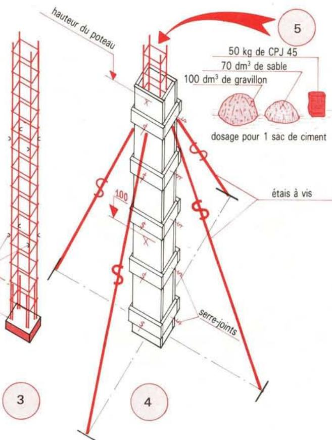
⑫ Schémas de visualisation pour la réalisation d'un POTEAU ISOLÉ.
