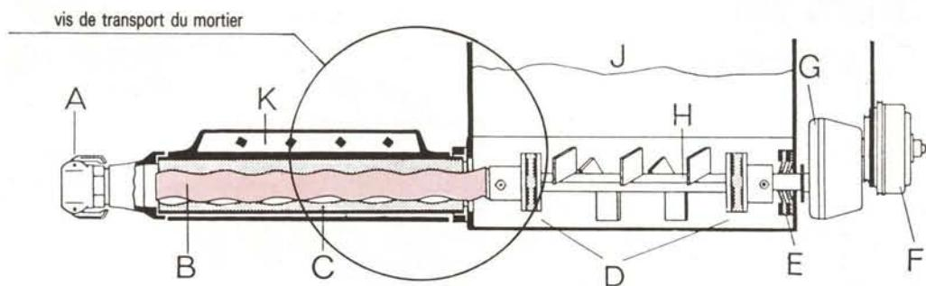
Shéma de principe des pompes à vis PM, P 11 (avec jaquette à rattrapage de jeu)
