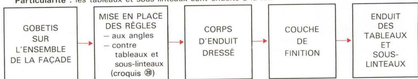
Cette variante d'application permet d'obtenir un corps d'enduit parfaitement dressé ; les règles plaquées servent de guides verticaux pour le dressement de la surface.
