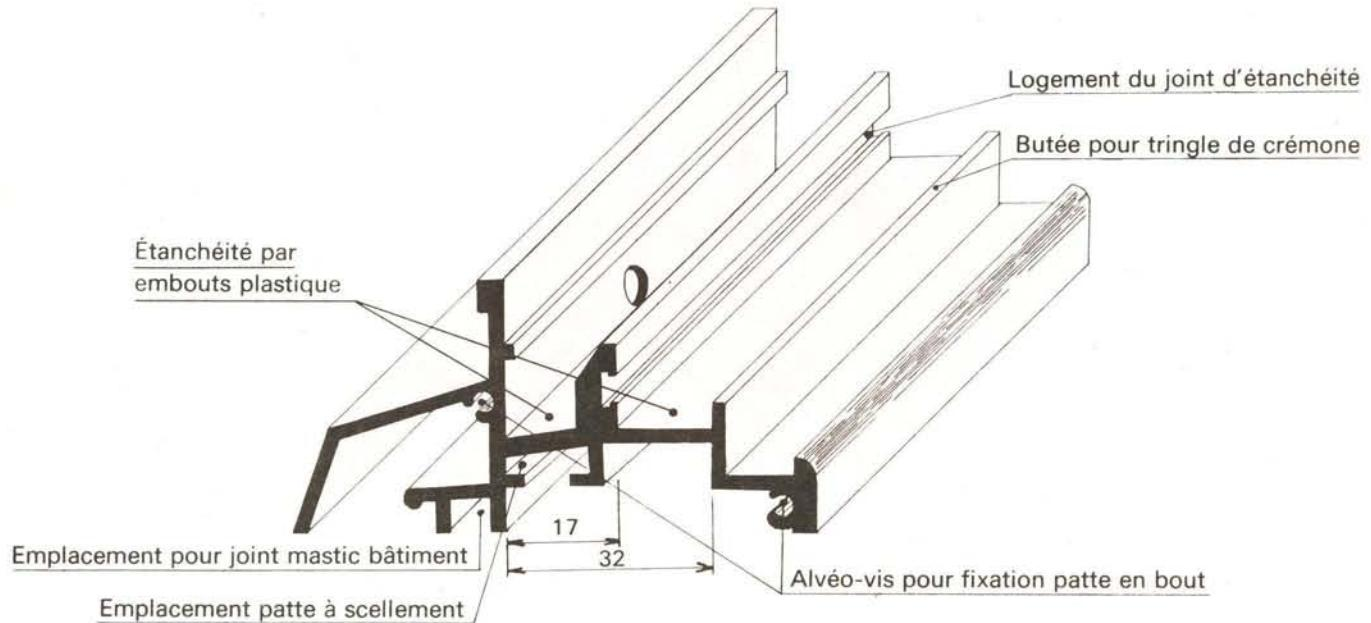
⑨ PIÈCE D'APPUI DE PORTE-FENÊTRE EN ALLIAGE LÉGER
