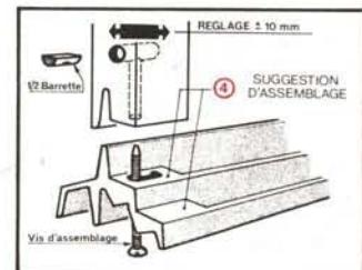
④ Détail d'une extrémité. Suggestion d'assemblage
