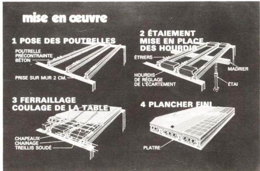
⑩ Schémas de visualisation de la mise en œuvre d'un plancher
