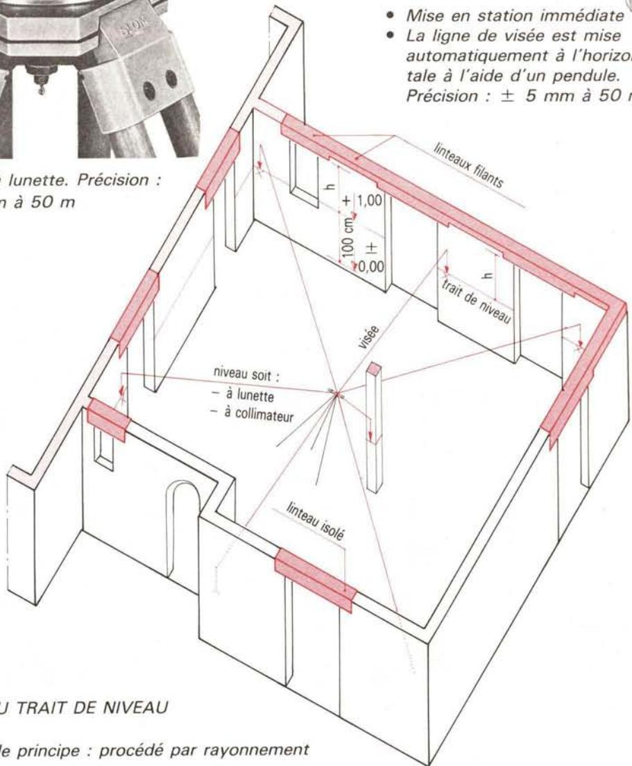
Schéma de principe : procédé par rayonnement
