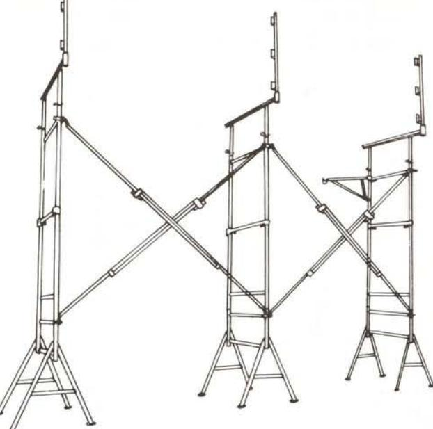
⑧ Échafaudage avec embases, échelles, garde-corps (montage par emboîtement)
