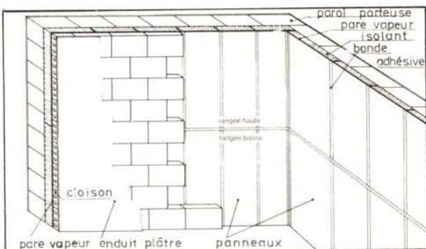
⑯ Paroi porteuse, isolant, cloison enduite
