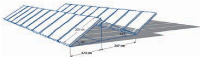
Production d'eau chaude sanitaire : les capteurs privilégient le soleil d'été.
