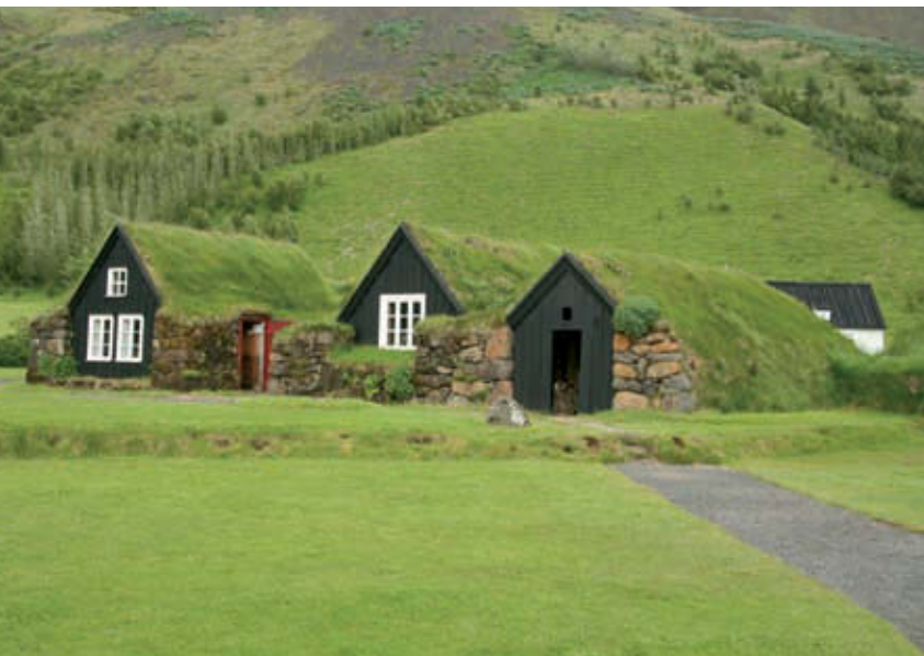
La toiture végétalisée est une pratique ancienne et fréquente en Islande pour protéger les constructions du froid.
