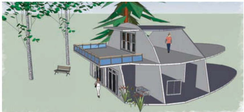
La charpente de la construction de la page 158 est à ossature interne. Les parois externes ne sont pas utilisées pour porter la charpente, leur seule fonction est d'isoler. L'inertie des parois porteuses est intérieure à la construction.
