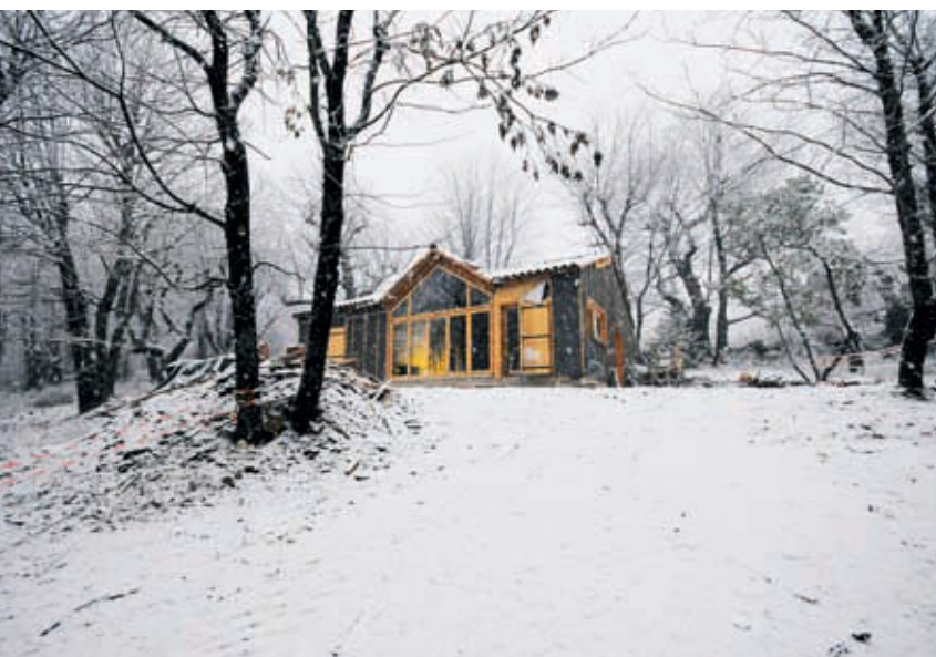
L'approche bioclimatique permet d'assurer un confort intérieur en tout lieu et en toute saison. Ici, maison individuelle de 100 m 2 à ossature bois avec isolation en matériaux naturels et serre bioclimatique au Collet-de-Dèze (48). (Photo et réalisation Les Charpentiers d'Uzès.)
