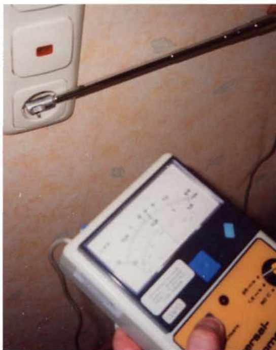
fig. 4-15 Mesure des fuites sur la prise électrique
