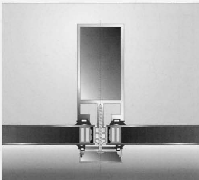
fig. 2-40 Coupe d'un système d'isolation pour façades
