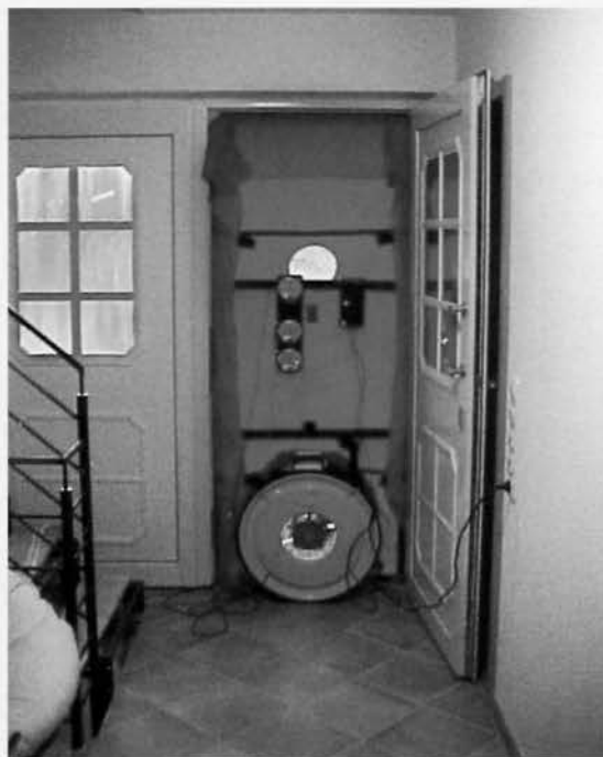
fig. 4-14 Test Blower-Door en état d'installation
