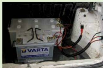
Les batteries dans le coffre arrière. On reconnaît le deuxième coupleur-séparateur ainsi que le relais.
