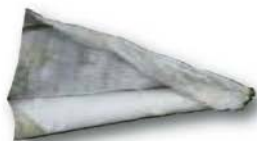
Feutre perméable. Déroulé sur le toit végétal, entre terre et cailloux, il empêche la terre d'entourer les cailloux, ce qui entraverait le drainage de l'eau.
