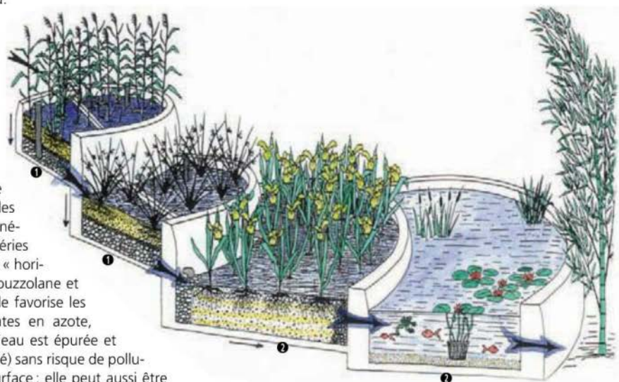
Filtre planté mis au point par Eau Vivante. Dessin d'Anne Rivière et Claudine Duchet. (1) : bassins de type vertical. (2) : bassins de type horizontal.
