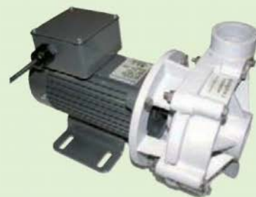
Cette pompe solaire commercialisée par Aquatiss consomme moins de 100 Wh pour un débit de 12 000 l/h (environ 350 €). Il faut néanmoins la raccorder à un panneau solaire de 1 m 2 d'au moins 125 Wc et l'associer à une batterie. Elle s'intègre dans une installation comportant 2 panneaux solaires et 1 éolienne.
