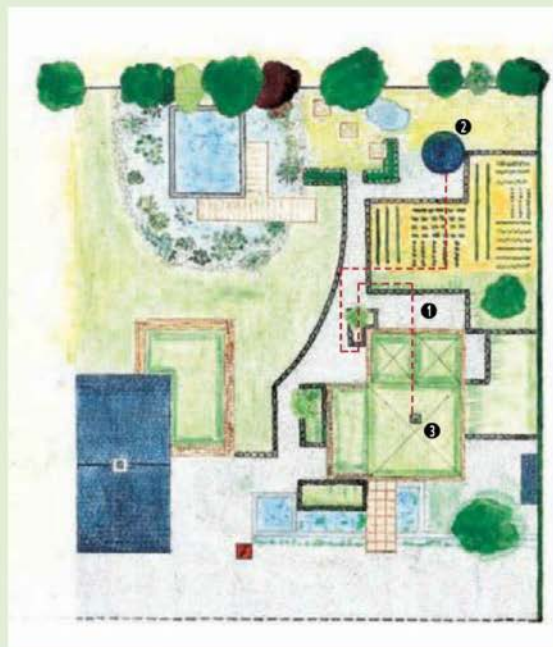
Le tuyau du puits canadien (1) part de la remise (2) et débouche dans l'habitat (3) devant le poêle de masse.
