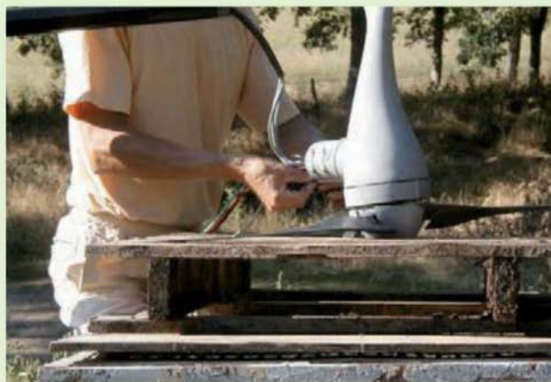
Cette éolienne légère, qui coûte moins de 1 000 €, est un appareil de type Air 400, raccordé sur une batterie d'une capacité de 240 Ah en 12 V. Même si les performances varient selon les endroits, on considère que sa production annuelle est d'environ 800 kWh. (Photo Christine et Laurent Choplin.)
