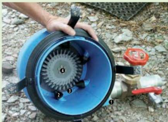
La turbine. Vous découvrez la vanne d'arrivée d'eau (1), les orifices par lesquels passent les jets d'eau sous pression (2) et les godets (3) qui permettent à la turbine (4) de tourner. (Photo Jean-Luc Girard/Passerelle éco.)
