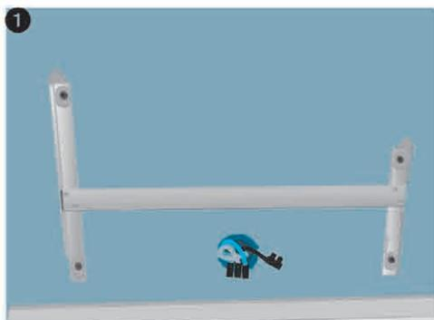
1 L'arrivée électrique doit se situer derrière l'appareil. Fixez le dossieret selon les recommandations du fabricant, en ce qui concerne la hauteur.
