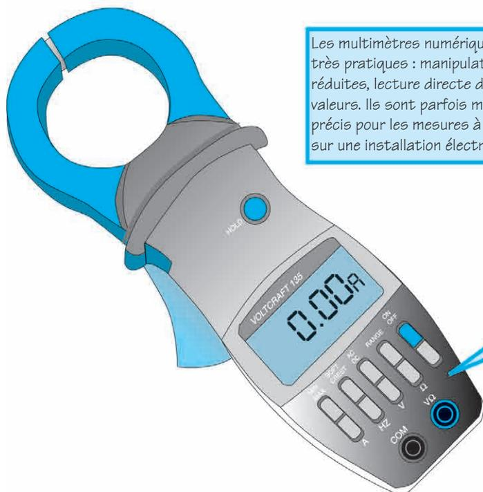
La pince ampèremétrique est très utile pour mesurer les intensités, surtout si elles sont élevées. Certaines permettent aussi de mesurer des tensions et des résistances. Il existe aussi des adaptateurs pince qui s'utilisent avec les cordons des multimètres.
