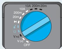
Sélectionnez le type de tension à mesurer : AC pour l'alternatif...
