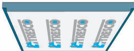
Un plafond rayonnant plâtre peut se réaliser avec des films ou avec des panneaux composés du film chauffant et de l'isolant (voir ci-dessus).
