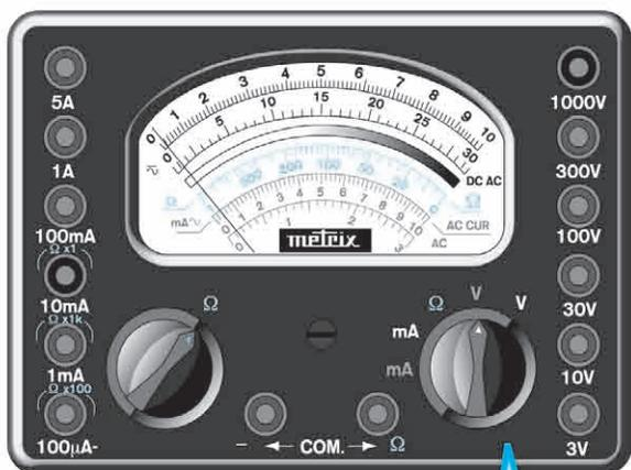
Les multimètres analogiques sont construits selon une ancienne technologie. La lecture des mesures se fait par la position de l'aiguille sur un cadran. Ce type d'appareil demande plus de manipulations qu'un modèle numérique. En revanche, son prix est moins élevé. Il est suffisant pour des tests sur une installation électrique.
