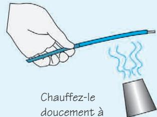
Chauffez-le doucement à l'aide d'un sèche-cheveux, d'un pistolet thermique ou même d'un briquet pour qu'il se rétracte et vienne coller au conducteur.
