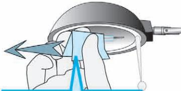
Saisissez l'ampoule avec un morceau de papier de soie et retirez-la de la douille.
