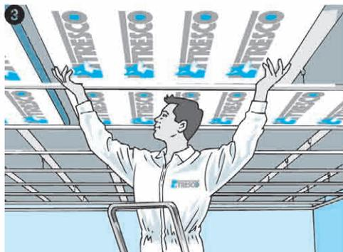
En fonction du plan de calepinage préétabli, placez les panneaux chauffants et les panneaux neutres. Les panneaux neutres peuvent accueillir des luminaires encastrés.
