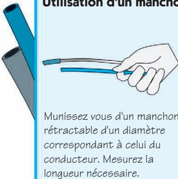
Munissez-vous d'un manchon rétractable d'un diamètre correspondant à celui du conducteur. Mesurez la longueur nécessaire.
