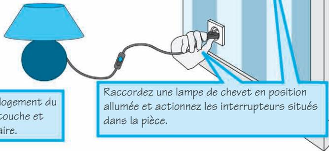
Raccordez une lampe de chevet en position allumée et actionnez les interrupteurs situés dans la pièce.
