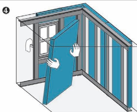
4 Insérez les lés derrière l'ossature et ajustez-les bord à bord.
