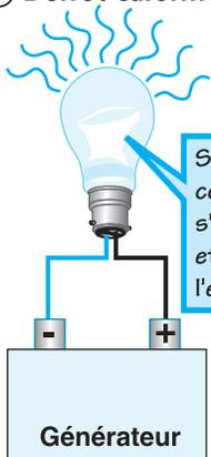
Sous l'effet du passage du courant électrique, la lampe s'allume, son filament rougit et dégage de la chaleur : c'est l'effet calorifique.
