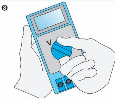
3 Réglez votre testeur sur la fonction voltmètre (calibre minimal de 300 V en monophasé et 400 ou 500 V en triphasé).
