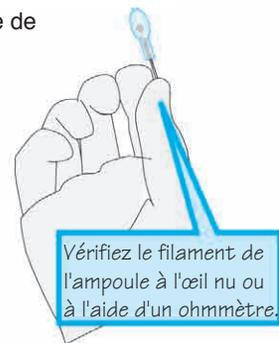
Vérifiez le filament de l'ampoule à l'œil nu ou à l'aide d'un ohmmètre.
