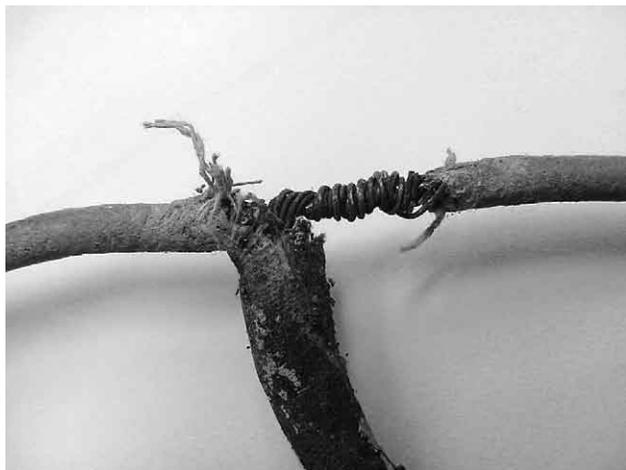
Figure 202 : Une ancienne épissure (interdit)
