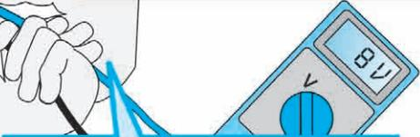
Mesurez la tension de sortie. Si la tension correspond au raccordement de la ligne (8 ou 12 V), le transformateur est bon. Si vous ne mesurez aucune tension, remplacez le transformateur.
