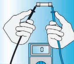
Figure 467 : Test des coupe-circuits avec un voltmètre
