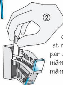
Figure 468 : La recherche d'un fusible détruit
