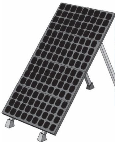
Installation au sol sur des supports réglés selon l'inclinaison offrant le rendement optimum
