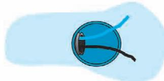
Tout conduit encastré alimentant un appareillage fixe doit aboutir dans une boîte de raccordement. Éventuellement autorisé pour l'alimentation directe d'un chauffe-eau électrique dans les volumes de la salle de bains.
