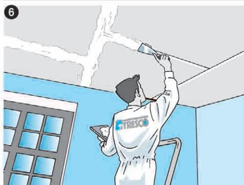
Réalisez les joints entre les plaques de façon traditionnelle.
