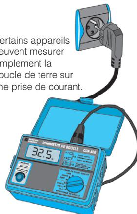
Figure 288 : La mesure de la prise de terre
