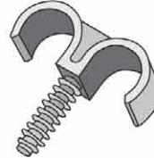
Il suffit de percer un trou d'un diamètre de 8 mm, de placer l'attache sur le tube et de l'enfoncer au marteau.
