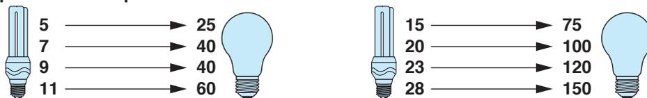
Figure 32 : Les lampes fluocompactes de substitution
