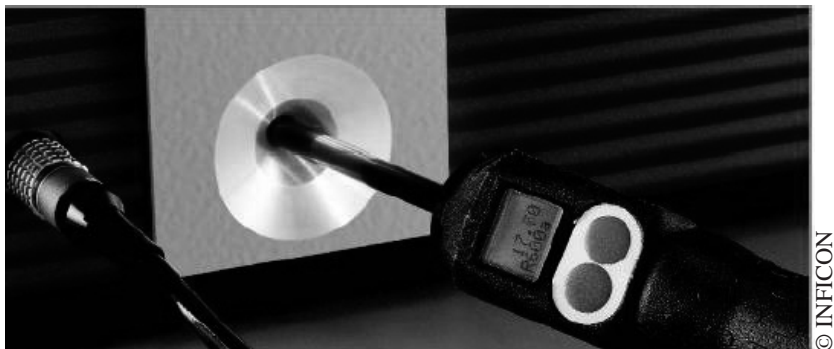
Figure 25 : Utilisation d'une fuite calibrée intégrée en reniflage
