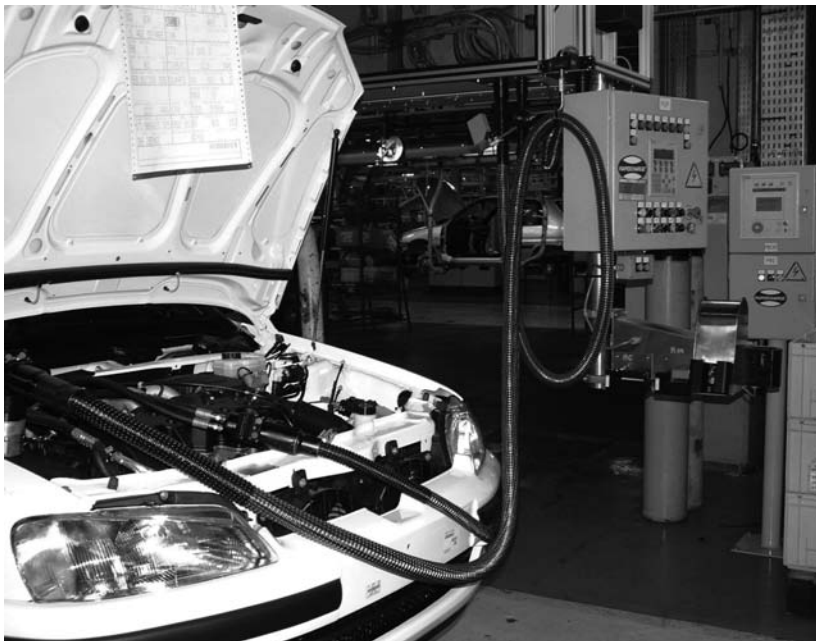
Figure 11 : Vérification de l'étanchéité des circuits avant remplissage
