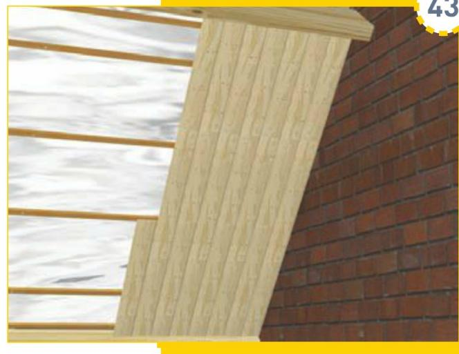
Afin d'avoir un support de pose pour l'isolant, on réalise au préalable une structure en tasseaux vissés au mur.
