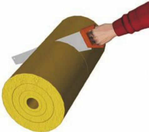
Il existe divers moyen de découper un isolant. Pour recouper un isolant en rouleau (ajustement de la largeur des lés), vous pouvez utiliser un couteau spécifique, une scie égoïne ou même un couteau électrique. Pour un panneau, on utilise un cutter et une règle.
