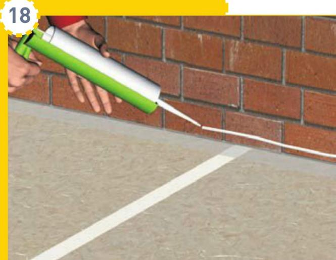
Déposez un cordon de mastic-colle à la base du mur, à hauteur adéquate pour y fixer la partie remontante du film. Utilisez de préférence le mastic-colle préconisé par le fabricant de votre film d'étanchéité.
