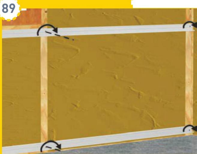
Pour la seconde couche d'isolant, nous avons choisi une pose sur ossature métallique, le système le plus aisé à mettre en œuvre. Sur les montants bois, vissez des fourrures disposées horizontalement sur toute la longueur du mur.
