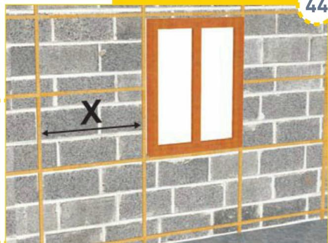
La pose de l'isolant se fait comme précédemment (voir p. 84). Posez ensuite une nouvelle structure de tasseaux, en vissant les tasseaux par-dessus ceux qui sont placés sous l'isolant. C'est cette seconde structure qui supportera le parement.
