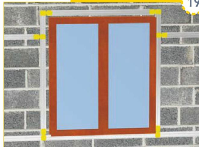
Les fourrures intermédiaires (horizontales) posées précédemment supportent des appuis intermédiaires. Ces appuis servent à leur tour à rigidifier les fourrures horizontales et d'autre part à fixer l'isolant (voir p. 51).
