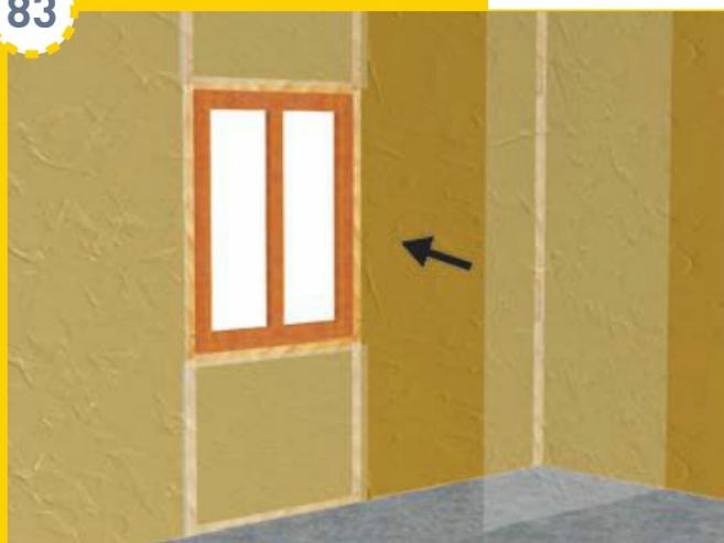
Agrafez la membrane d'étanchéité sur les montants.
