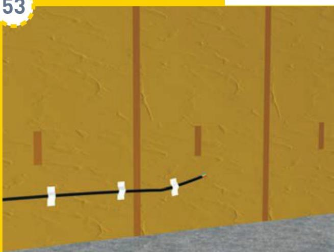
Les gaines électriques doivent être installées devant l'isolant. Maintenez-les en place avec du ruban adhésif.
