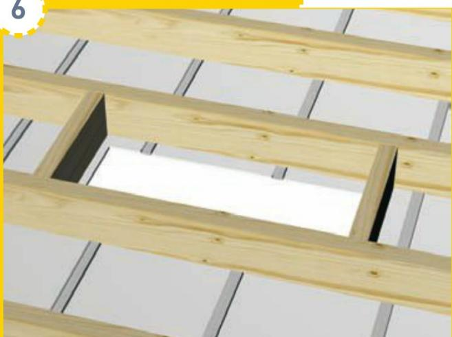
Isolez la trappe d'accès avec un isolant en rouleau ou en panneau dont le coefficient R est au moins égal à celui de la laine soufflée. Vous pouvez le coller, par exemple avec un mortier adhésif.
