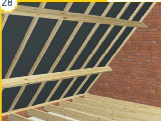
L'isolation de combles aménagés consiste prioritairement à isoler la toiture de l'intérieur, en s'appuyant sur la charpente (les rampants). Choisissez l'isolant selon la performance d'isolation que vous souhaitez atteindre (RT 2005, RT 2012, BBC 2005...). Pour cela, reportez-vous aux chapitres précédents (voir notamment p. 19). Selon la résistance thermique R que vous cherchez à atteindre, il vous faudra poser une ou deux couches d'isolant.
