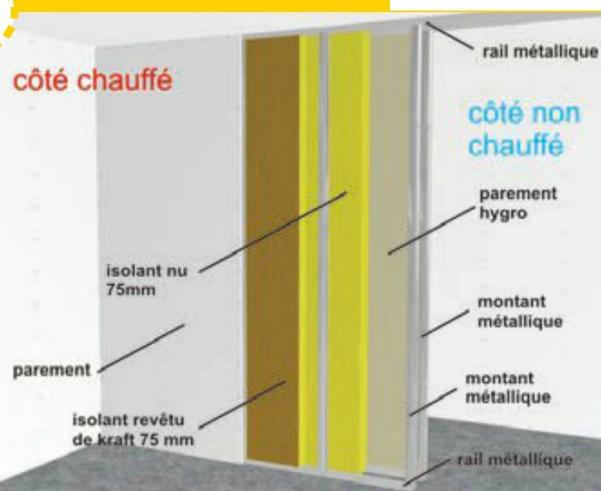
Ci-contre, schéma d'une cloison séparative entre une pièce chauffée et une autre non chauffée offrant une excellente isolation tant thermique qu'acoustique.
