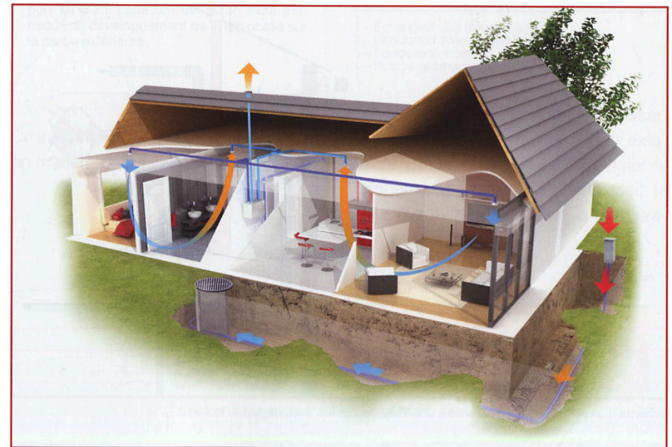
Schéma VMC double flux Duolix d'Atlantic (été)
