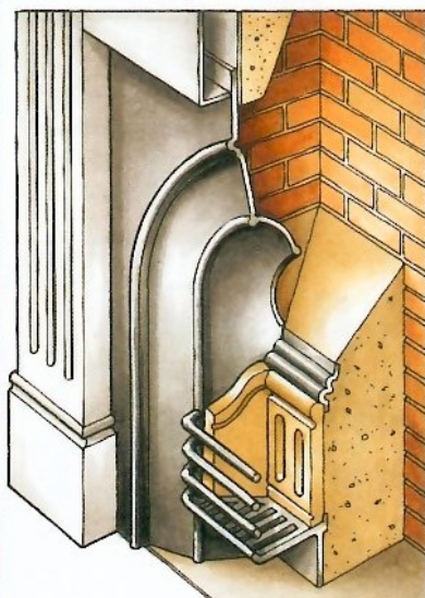
Remplissez de béton l'espace derrière l'âtre.
