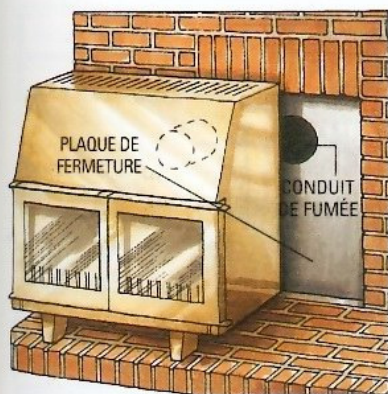
1 Une plaque en tôle ferme l'ouverture du foyer.
