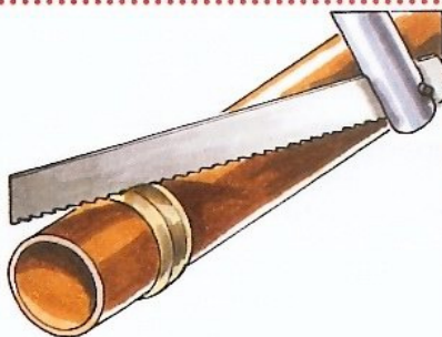
Sciez avec précaution en diagonale.
