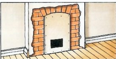
Assurez la ventilation d'une cheminée inutilisée.
