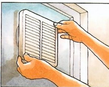
1 Placez la grille extérieure dans le logement.
