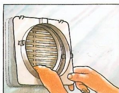
2 Fixez les platines interne et externe sur le conduit.
