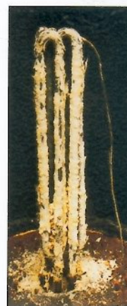
Résistance entartrée Les dépôts de tartre sur les résistances de machine à laver et de chauffe-eau peuvent réduire leur efficacité de 15 à 70 %.
