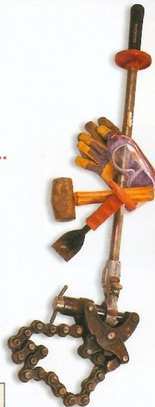
Coupe d'une conduite Le coupe-tube à chaîne assure une coupe droite.
