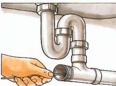
Cassez le bouchon avec un fil de fer à bout crochu.
