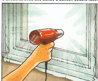
5 Chauffez le film avec un sèche-cheveux.
