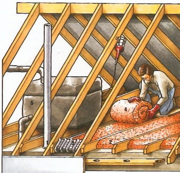
Pose de bandes d'isolant sur le plancher du comble
