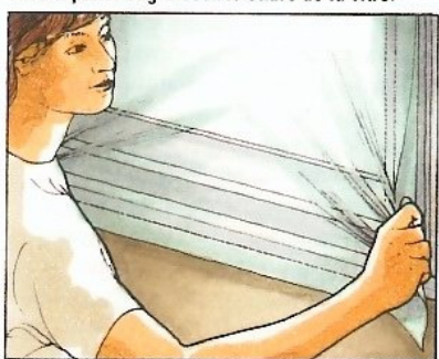
4 Tendez le film et fixez-le sur les côtés et en bas.
