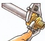
2 Serrez avec deux clés en opposition.
