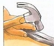
Refermer un tube éclaté En urgence, refermez le tube à petits coups de marteau et brasez la zone fendue ou recouvrez-la d'un emplâtre époxy.
