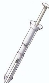
Cheville à clouer Insérez la cheville dans un trou percé dans le mur, puis clouez la plaque avec une pointe spéciale piquée au centre de la cheville.
