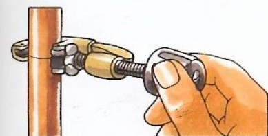
1 Serrez la molette coupante sur le tube.
