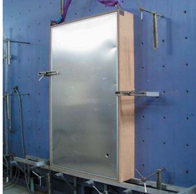
☒ Capteur solaire en cours de test de résistance au vent (CSTB Champs/Marne)
