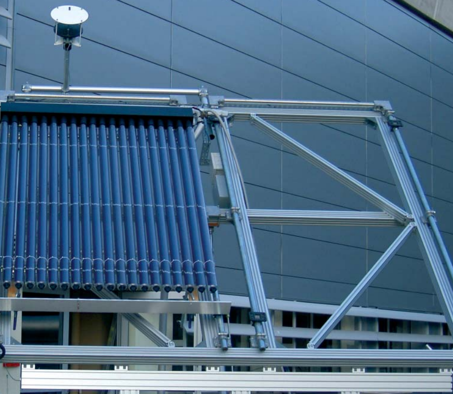
☒ Capteur solaire en cours de test de résistance au vent (CSTB Champs/Marne)
