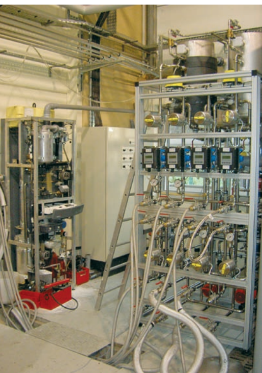
^ Pompe géothermale à absorption en test sur le banc semi-virtuel
