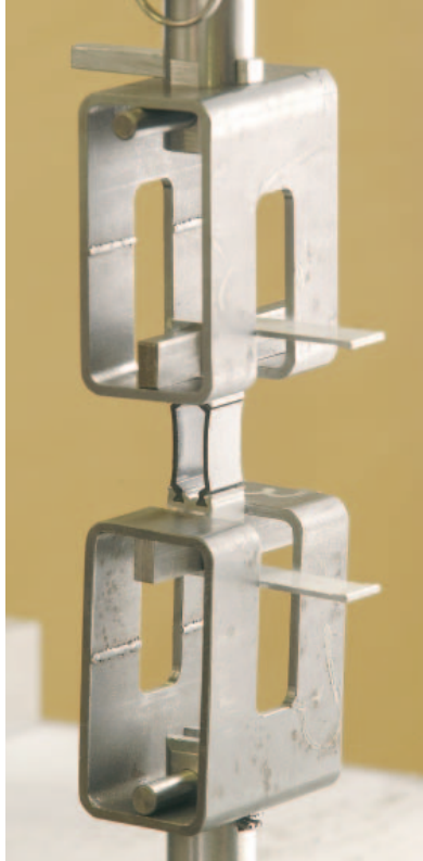
⤴ Essai de traction sur profilé alu à rupture de pont thermique
