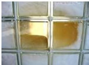
Différents états des MCP (matériaux à changement de phase) en fusion dans des briques de verre
