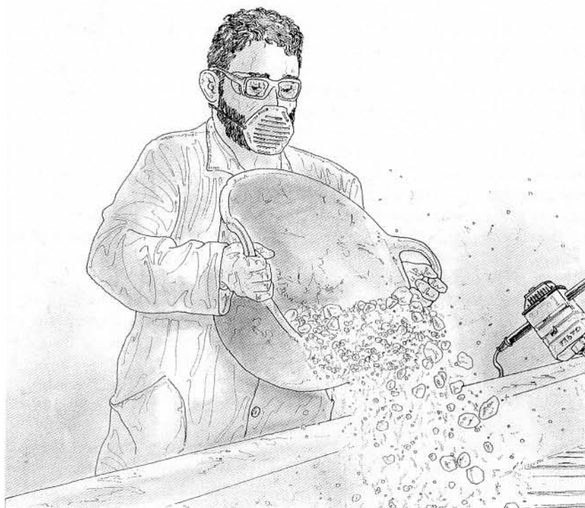
4. En entrant en contact avec l'eau, la chaux vive dégage de la vapeur.
