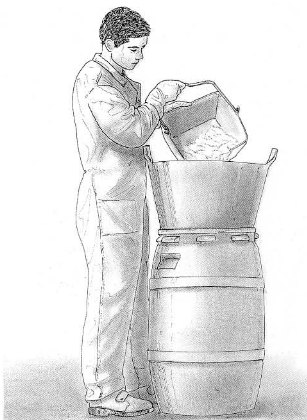
2. Tamisage de la chaux éteinte et froide.
