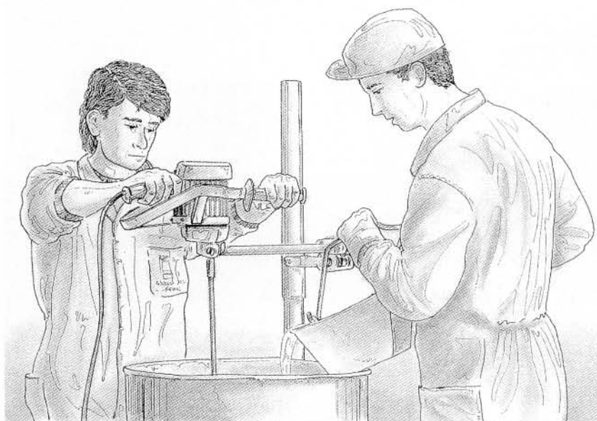
4. Ajout d'une certaine quantité d'eau et malaxage du mélange d'eau et de chaux.
