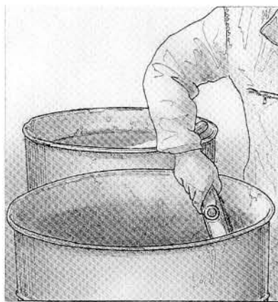
12 et 13. Nettoyage du bord intérieur du bidon avec une truelle et un pinceau trempé dans de l'eau.
