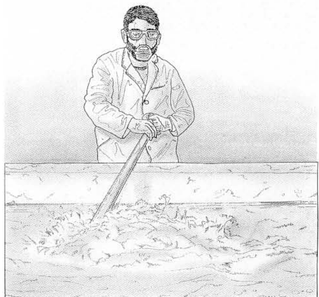
10. On remue la chaux pour qu'elle ne se dépose pas au fond.
