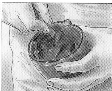
1 et 2. Dans des mortiers en verre, on mélange deux types de pigment avec de la chaux, à raison de 5 % de couleur.
