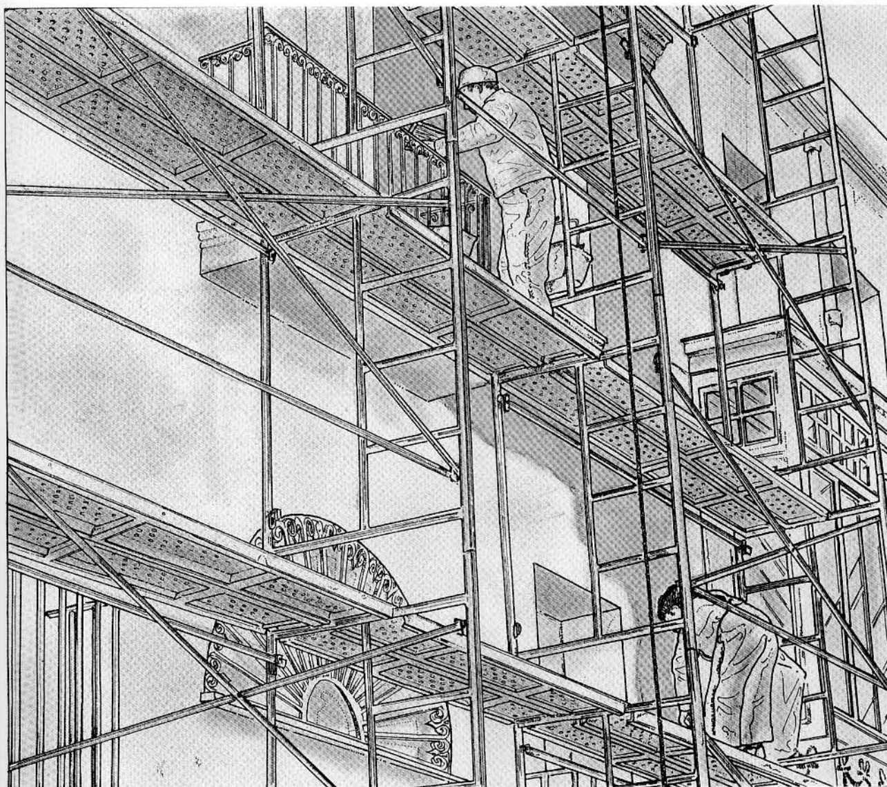
6. Application de la première couche maigre. À cette étape, on laisse de côté les jambages et les linteaux.
