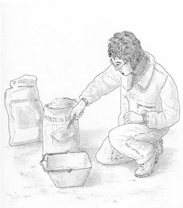
14. La peinture peut se fabriquer avec de l'hydrate de chaux en poudre.
