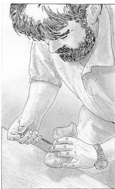
6. Il ferme le tampon avec une cordelette.
