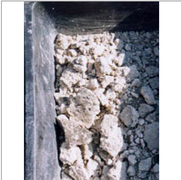
47 - Mortier prélevé. Il sera pilé pour séparer les éléments qui le composent sans les broyer.
