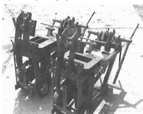
FIGURE 229 : PRESSE TERSTARAM. LA CHAÎNE EN S'ENROULANT AUTOUR DE L'ARBRE, FAIT REMONTER LE LEVIER QUI AGIT SUR LE PISTON.
