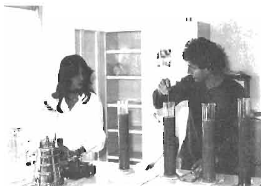
FIGURE 247 : SEDIMENTOMETRIE, MESURE EN LABORATOIRE
