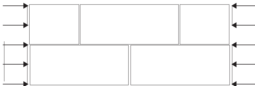
Fig. 5 : résistance d'une maçonnerie chargée parallèlement au lit de pose des éléments
