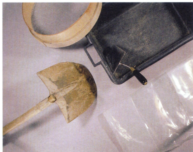
Très peu de matériel sera nécessaire au gâchage du mortier. Tamis, auge à gâcher, truelle de maçon, pelle et feuille de polyéthylène.
