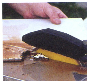
Exécutez des traits de sciages parallèles sur les chutes restantes. Affinez par un léger passage tangentiel de la découpe sur la lame, en faisant pivoter précautionneusement le carreau.
