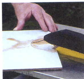
Attaquez le sciage dans le 2 e angle et re-jointez la fin du trait de scie précédent.
