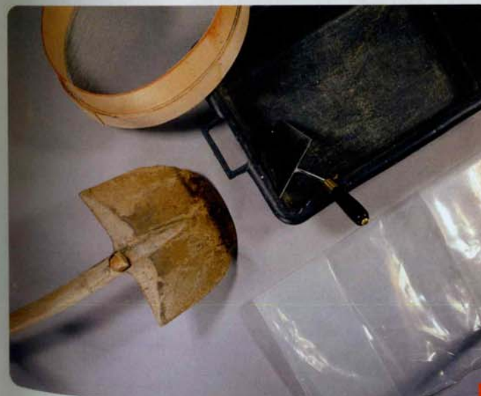
1 Très peu de matériel sera nécessaire au gâchage du mortier. Tamis, auge à gâcher, truelle de maçon, pelle et feuille de polyéthylène.
