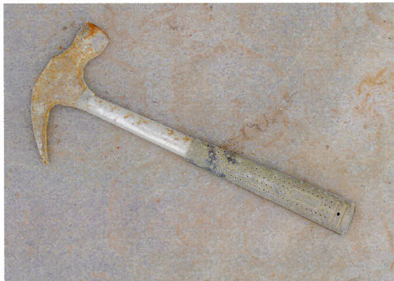
Les vibrations obtenues avec le marteau ventousent la pièce à sceller sur le mortier.
