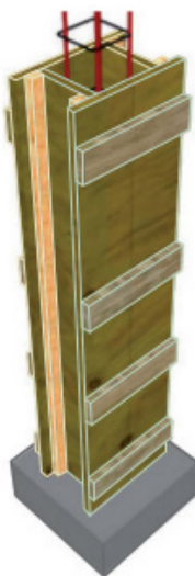
Fermeture du coffrage par pose de la deuxième demi-coquille
