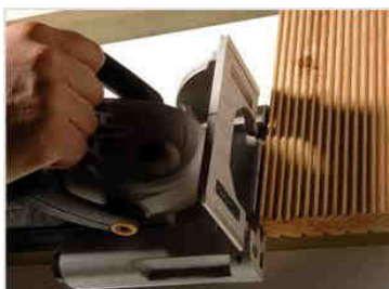
Usinage de la rainure
