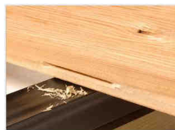
Lame fraisée (profondeur 13 mm)
