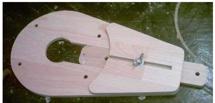
Ci-dessus mon second essai, que j'ai un peu « figolé » et avec lequel j'arrive à faire des cercles de 70 cm, grâce aux 3 trous pratiqués dans le curseur. Le passage de fraise ayant été agrandi à 50 mm.
