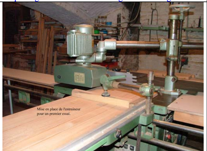
Photo 6: entraîneur: l'utilisation d'un entraîneur à rouleau permet un travail en toute sécurité et un pressage constant sur toute la longueur de la pièce.
