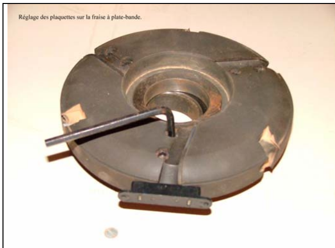
Photo 1: Fraise : il est important de bien positionner les plaquettes à l'aide de l'outillage généralement fourni avec le porte outil.
