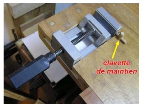
Et puis, le plus important peut-être, pour qui veut se consacrer au travail du bois : l'étau presse d'établi. Un vrai, à serrage parallèle guidé, qui maintient fermement les pièces travaillées qui ne se dérobent pas sous la frappe des maillets ou l'action des rabots, ciseaux et autres râpes.
