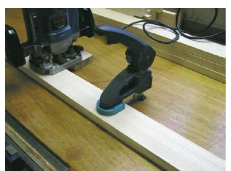
Le "valet" de droite, également très efficace, est un serre-joint à serrage excentrique cranté, acheté en GSB pendant les soldes.
