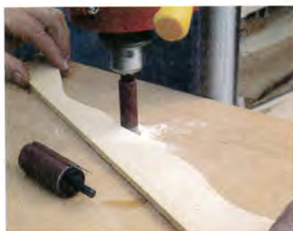
Le ponçage avec des cylindres peut devenir une opération très simple, si tant est qu'il ne requiert pas un tambour oscillant.
