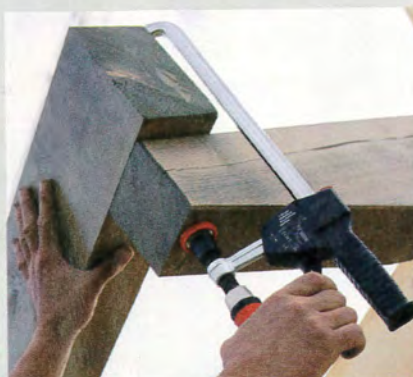
Pour des ouvrages en hauteur ou difficiles d'accès, cette presse une main développe tout de même une puissance de serrage de 5 000 N.
