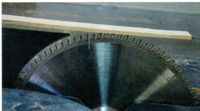
Le couteau diviseur est réglé quelques millimètres sous la hauteur de la lame.
