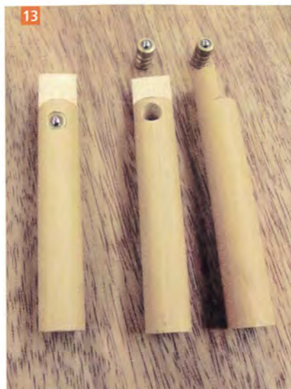
◀ Les griffes d'établi sont fabriquées à partir de tourillons de 19 mm de diamètre. Leur partie supérieure, utilisée pour le serrage, est inclinée de 2^\circ .
