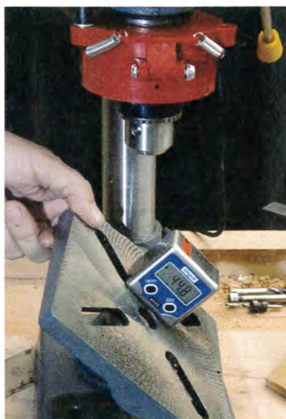
La table peut généralement être déplacée latéralement grâce aux vis de pivot qui la maintiennent par en dessous.
