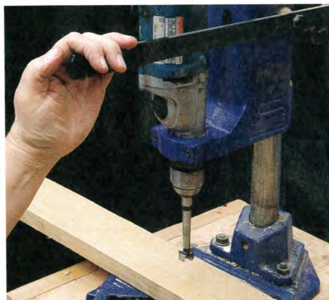
Une alternative à la perceuse à colonne peut être envisagée en montant une perceuse électrique sur un support mobile de perçage.
