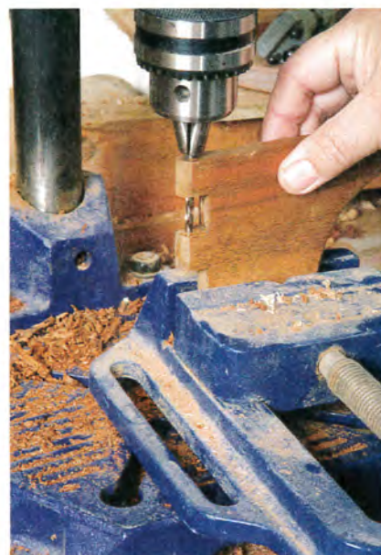
Afin de percer précisément à la verticale, comme avec des charnières, il est préférable d'utiliser un étau pour fixer la pièce.
