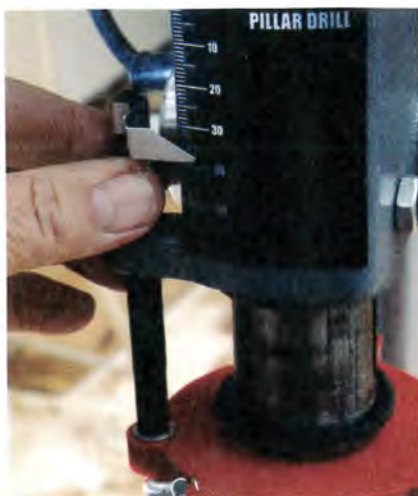
Le repère du guide de plongée est gradué... mais il faut s'y référer avec prudence, car le calibrage est souvent approximatif.
