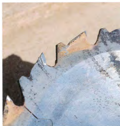
La dépouille de la dent carbure est comblée par la résine.
