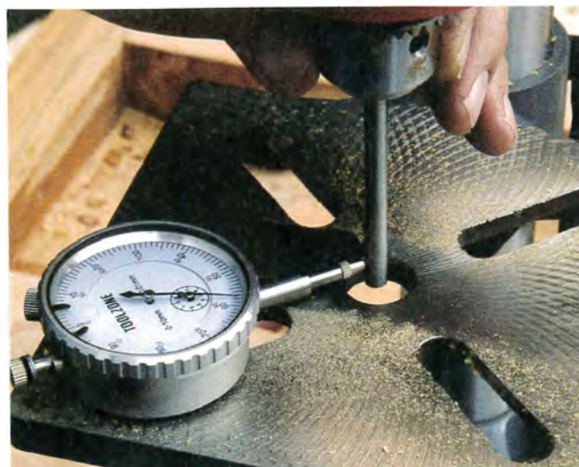
La vérification de l'alignement de la mèche et du mandrin s'effectue à l'aide d'un comparateur.
