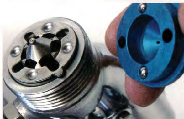
Derrière la tête de pulvérisation, on découvre des clapets à billes qui interrompent l'alimentation en air des évents des oreilles.
