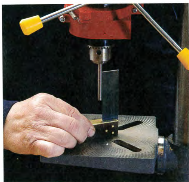
Vous vérifierez aussi l'alignement perpendiculaire de votre table par rapport au mandrin à l'aide d'une équerre.
