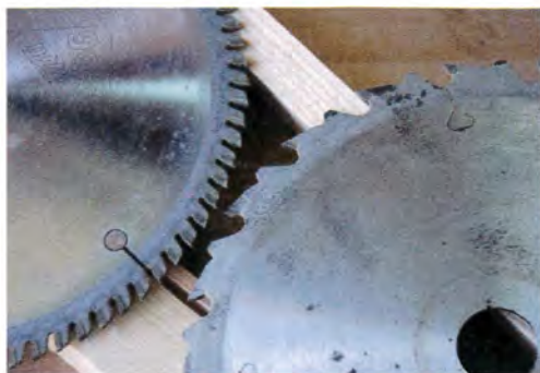
À gauche, une lame pour coupe fine ; à droite, une lame de débit avec dents antirecul.
