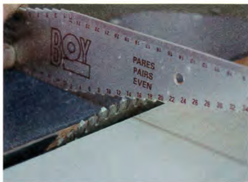
Réglage de la hauteur à la règle de toupilleur.
