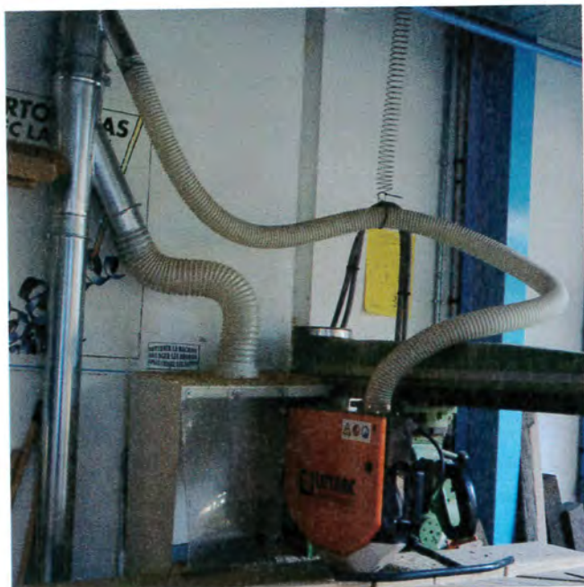
Cette scie radiale bénéficie du double système : encoffrement de la lame et carter de récupération des projections de sciures.
