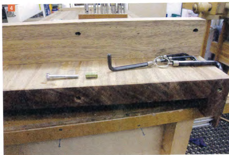
Fixation des planches d'extrémité : remarquez les trous oblongs qui permettront de s'accommoder des variations dimensionnelles du bois.
