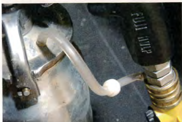
Le réservoir d'un pistolet HVLP est mis sous pression grâce à une dérivation sur l'arrivée d'air.
