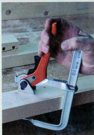
Pour bloquer, il suffit de tirer sur la poignée.
