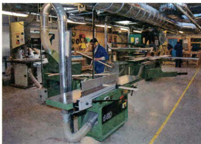
Le raccordement de la raboteuse exige un tuyau de sortie de forte section.
