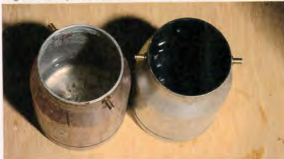
Les godets de pistolet en aluminium peuvent être corrodés par les finitions à base aqueuse. Il vaut mieux utiliser un godet revêtu de Téflon.
