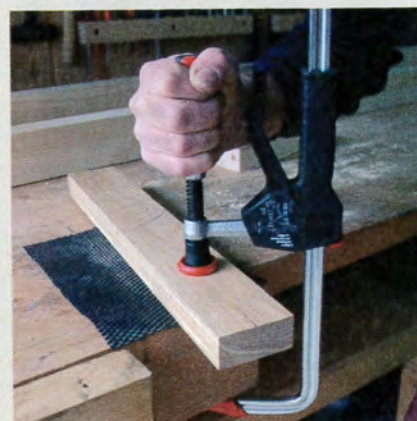
Pour assurer le blocage, on termine par la rotation de la poignée à vis.
