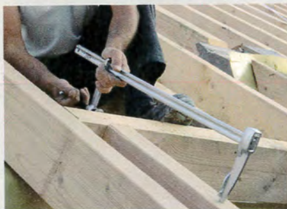
Presse de charpentier. Valet avec face de frappe pour une fixation rapide dans les chevrons, et robuste rotule à bague inclinable jusqu'à 35°.
