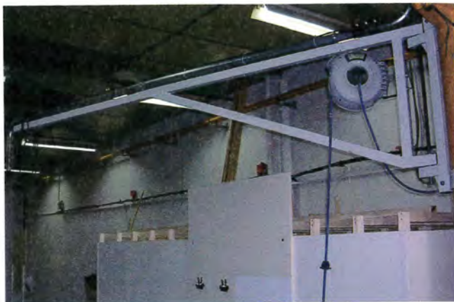
Dans un atelier, on ne pense pas assez à la potence. Il s'agit pourtant d'un système peu encombrant qui permet de couvrir une large surface.
