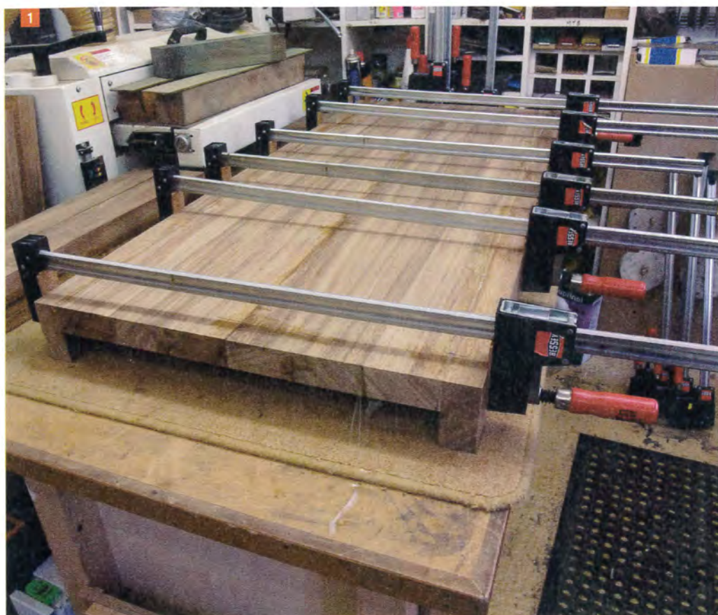
Mise en place de la ceinture du plateau à l'aide de dominos Festool.
