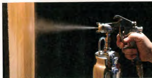
Avec les systèmes à haute pression, il est possible de déplacer le pistolet à grande vitesse (démonstration avec de l'eau).
