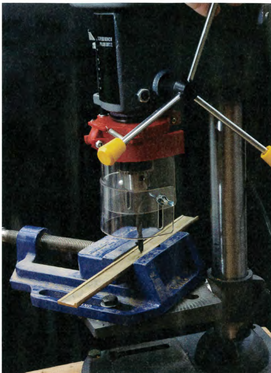
▲ Une extension de table en bois avec un guide vertical permet de développer les capacités de travail et de protéger les mèches et les pièces de bois lors de perçages débouchants.
