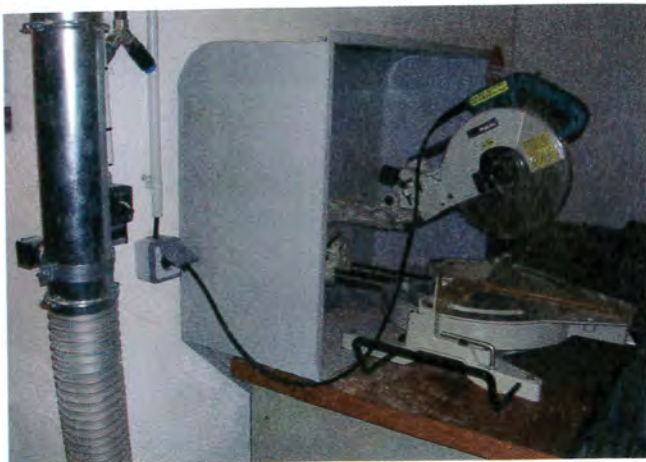
Les sciures émises par une scie radiale sont toujours très difficiles à capter. Un généreux carter sur l'arrière, englobant l'ensemble de la machine, est une solution astucieuse.
