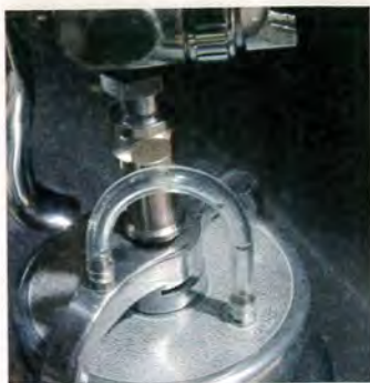
Le couvercle d'un pistolet traditionnel à dépression est mis à l'air libre.
