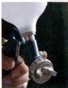
L'orifice de pulvérisation est encadré par des oreilles percées d'évents qui servent à profiler le jet.
