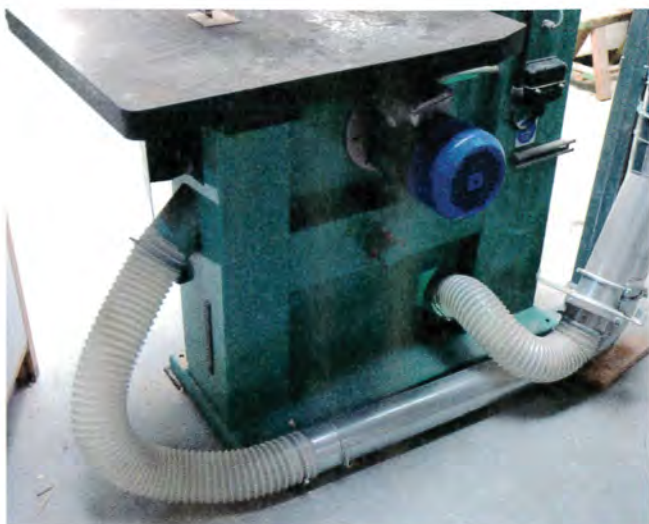
Récupération des sciures sur une scie à ruban au niveau du volant et du fond de carter.
