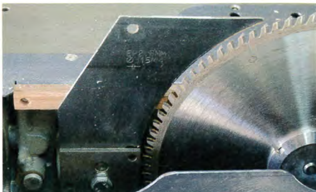
Pour être efficace, un couteau diviseur doit être bien réglé.
