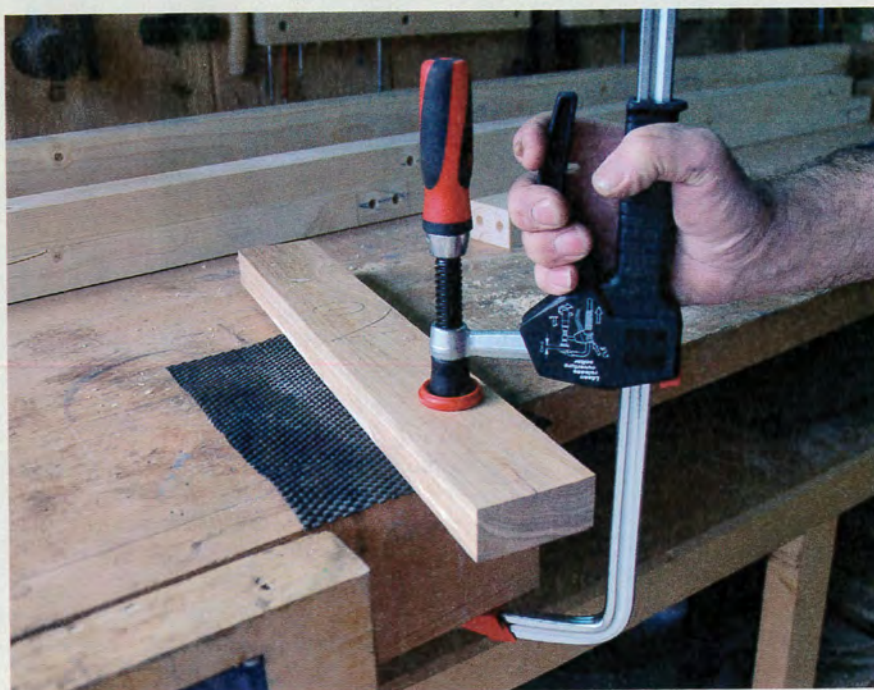
Pour approcher le serrage, il suffit d'appuyer sur la poignée vers le rail ou la poignée à vis.
