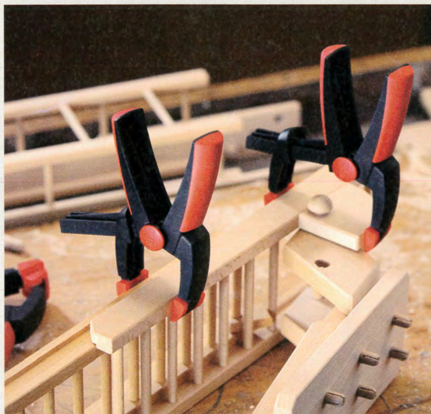
Certaines pincettes à ressort permettent des serrages d'une main, quelle que soit l'ouverture de serrage souhaitée.
