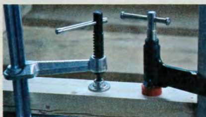
À droite, serre-joint à pompe, pas de vis conique ; à gauche, serre-joint à vis, pas trapézoïdal.
