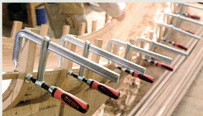
Serrage efficace et peu encombrant avec les presses à vis tout acier. Idéal pour le lamellé-collé.
