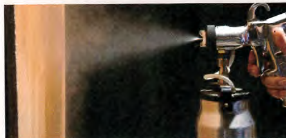
Avec les systèmes HVLP, il faut déplacer le pistolet beaucoup plus lentement ; en revanche, le jet est beaucoup plus large.
