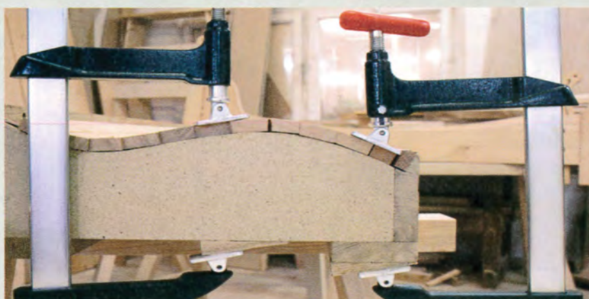
Serre-joint équipé de patins pour serrage biais sans calage.
