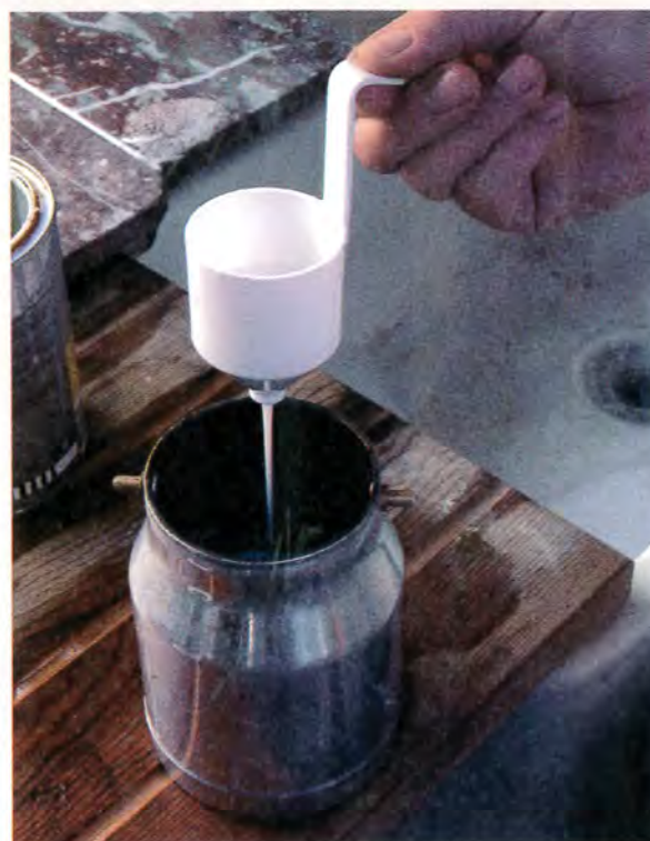
La coupe du viscosimètre permet de mesurer l'épaisseur du liquide.
