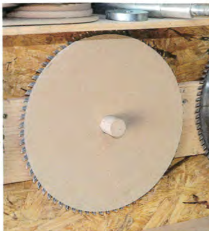
Une rondelle de carton pour empêcher le contact des lames de scies entre elles...
