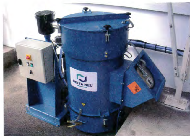
Centrale de dépoussiérage haute dépression. Concentration de poussières maxi de 5 g/m 3 , et débit d'air de 300 à 600 m 3 /h, nettoyage par air comprimé, automatique en fonctionnement avec séquenceur.
