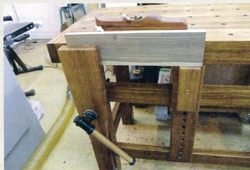
Dressage d'un chant en utilisant le support intermédiaire coulissant.
