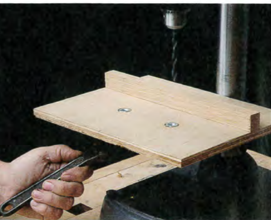
▲ Une extension de table en bois avec un guide vertical permet de développer les capacités de travail et de protéger les mèches et les pièces de bois lors de perçages débouchants.
