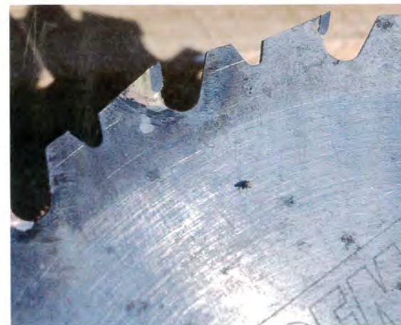
Les dents cassées peuvent être remplacées.
