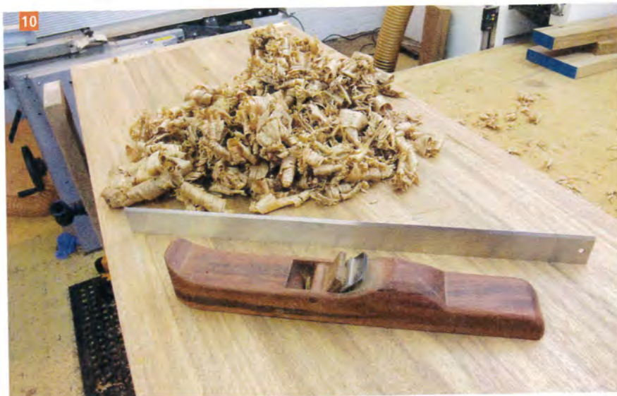
Dégauchissez la surface du plateau avec un rabot de bonne longueur bien affûté.
