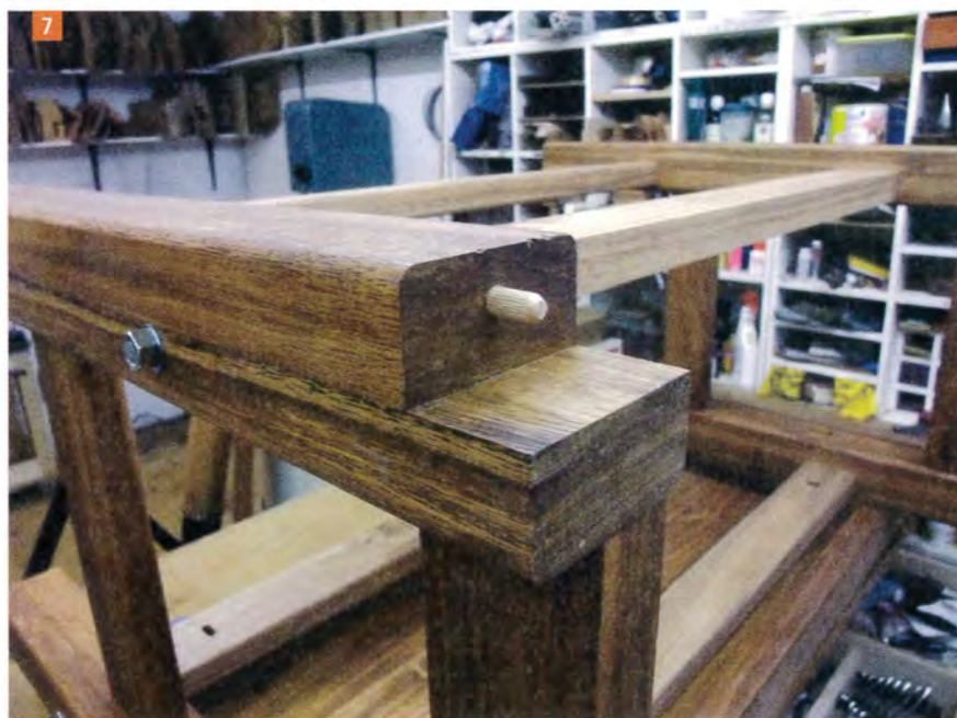
Des tourillons assurent le positionnement du plateau et alignent la face avant des pieds avec l'avant du plateau.
