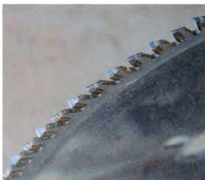
Une denture plate trapézoïdale.
