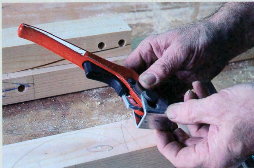
Tout le secret d'un bon fonctionnement réside dans le basculement du patin et la crémaillère de serrage.
