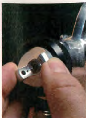
En faisant tourner la tête de pulvérisation, on change la forme du jet.
