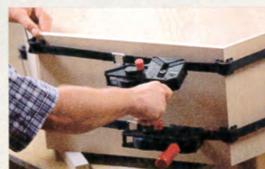
Le serrage par sangle peut se décliner de différentes manières. C'est une méthode souple d'utilisation, polyvalente et peu onéreuse.
