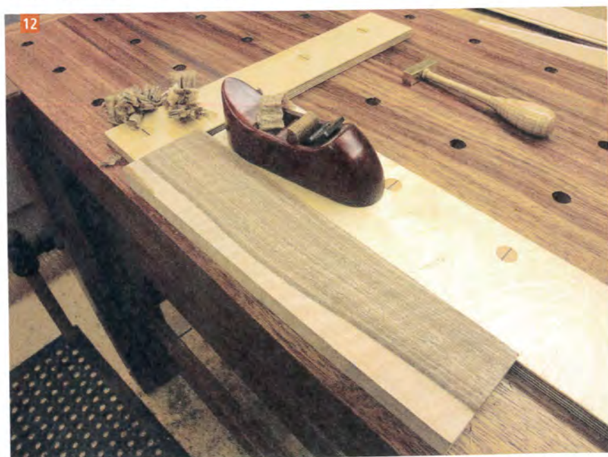
Les butées de rabotage permettent de bloquer la pièce dans deux directions.
