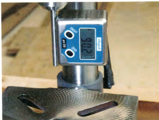
Vérifier l'alignement vertical de votre mandrin à l'aide d'un inclinomètre vous permettra d'obtenir un calage parfait.
