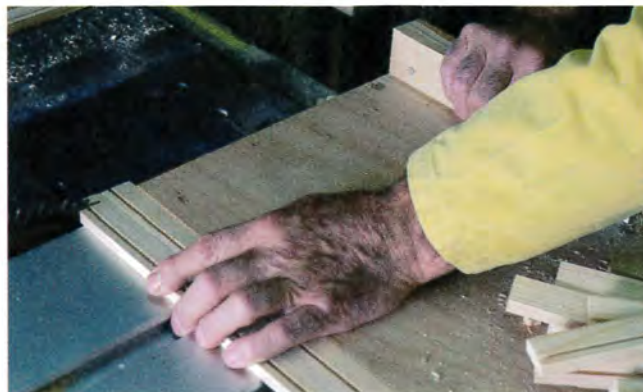
Pour le travail en série : d'un côté, on coupe d'équerre...
