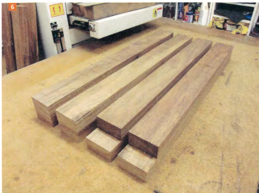
Les pieds ont été collés et mis à dimension ; remarquez l'encoche sur les pieds avant, qui permet leur affleurage à l'avant du plateau.
