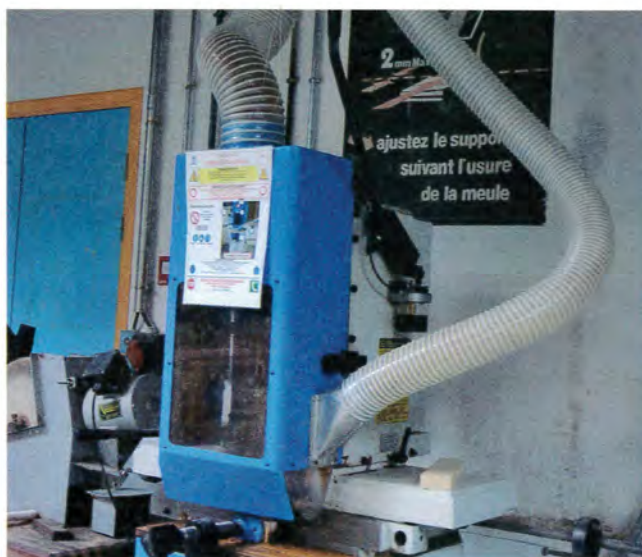
L'encoffrement des machines est la meilleure solution pour le captage direct des poussières au plus près de la source d'émission.
