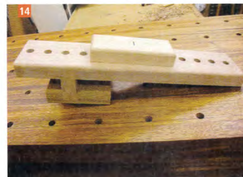
▼ Le support coulissant intermédiaire avec sa butée.
