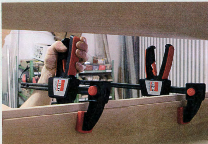
Cette presse légère ne développe que 2 000 N maximum de force de serrage pour un poids de 900 g...
