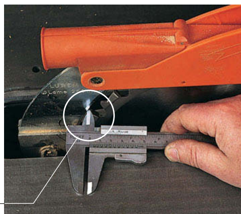
couteau diviseur placé à 4 mm de la lame
