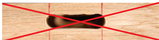
Mortaise incorrecte : l'assemblage sera trop lâche.
