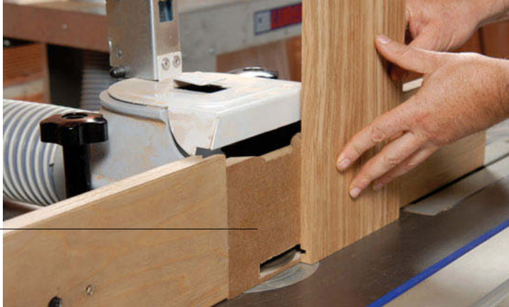
Toupillage à l'aide d'une plaque de guidage continue.
