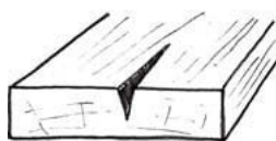
Fente ou gerce de séchage.
