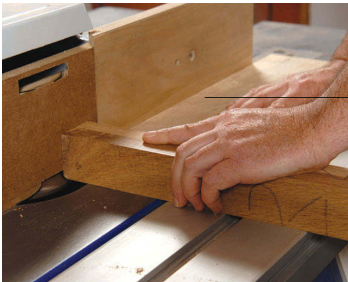
Toupillage à l'aide d'une plaque de guidage.
