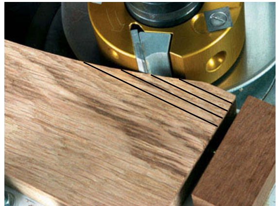
Usinage à contre-fil.
