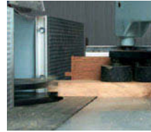
Exécution d'un tenon.
