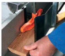
Touillage d'une pièce rectiligne.
