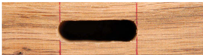
Mortaise respectant le tracé. L'assemblage sera solide.
