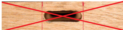
Mortaise incorrecte : l'assemblage sera impossible.
