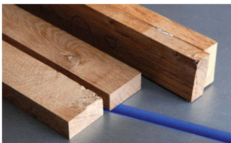
Collage de deux pièces. Il faut être attentif à placer l'une contre l'autre les deux faces comportant des défauts.
