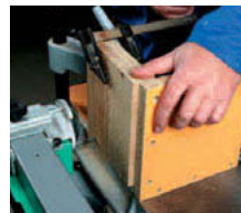
Usinage d'un assemblage par tourillons.
