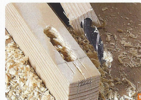
9 Complétez le traçage par un renfort d'épaulement ainsi que par un trait d'axe de la mortaise. Vous utiliserez ce trait pour positionner la mèche munie d'une pointe de centrage.
