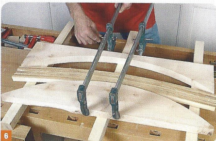
5 Préparez un lit de collage (pour pouvoir le cas échéant placer des serre-joints sous la pièce à coller et pour éviter de salir votre plan de travail avec la colle qui sortira inmanquablement des joints). Encollez les deux faces des lames à assembler (utilisez une colle à temps ouvert long) et installez-les entre les cales de serrage.
