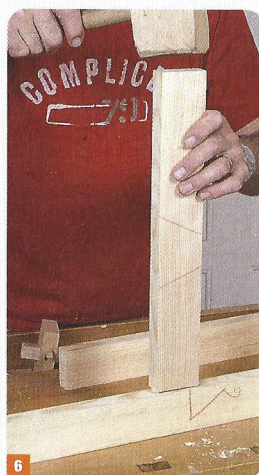
6 Sciez le tenon, puis, contrôlez l'ajustage tenon mortaise.
