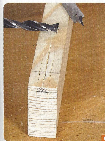
9 Complétez le traçage par un renfort d'épaulement ainsi que par un trait d'axe de la mortaise. Vous utiliserez ce trait pour positionner la mèche munie d'une pointe de centrage.
