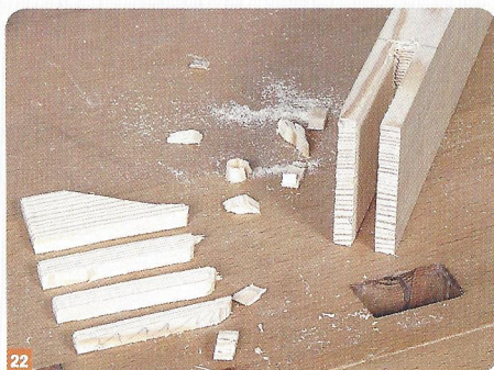
22 La fourche est dégagée, les chutes montrent les différentes phases de l'entaillage.
