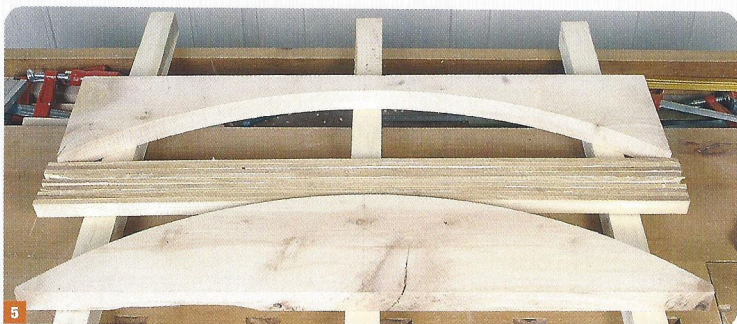
5 Préparez un lit de collage (pour pouvoir le cas échéant placer des serre-joints sous la pièce à coller et pour éviter de salir votre plan de travail avec la colle qui sortira inmanquablement des joints). Encollez les deux faces des lames à assembler (utilisez une colle à temps ouvert long) et installez-les entre les cales de serrage.
