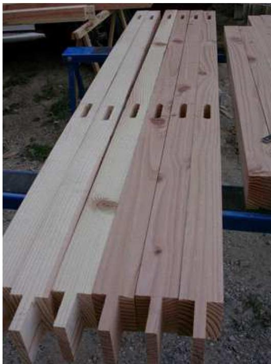
Une partie des montants verticaux avec leurs tenons et mortaises
