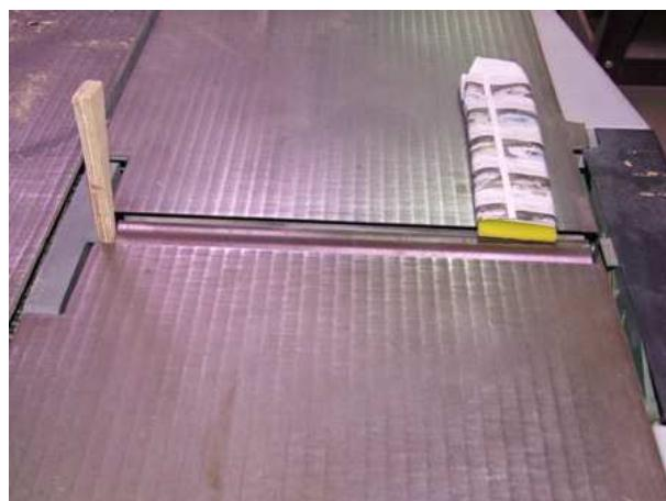
2. Positionner le premier fer de façon à ce que la surface de dépouille se trouve parallèle à la table d'entrée (c'est très près du plan de la table d'entrée).
