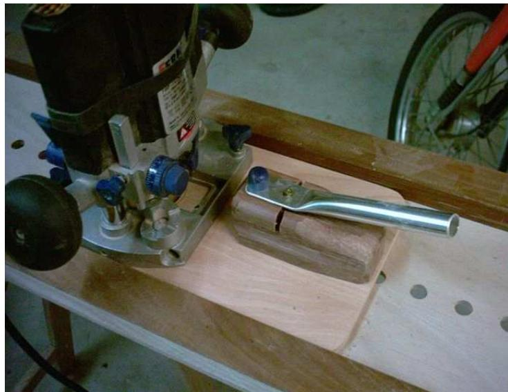
J'avais à percer 3 séries de trous dans chaque côté de 9 penderies soit +/- 3.200 trous, grâce à cet appareil, ces 3.200 trous ont été percés à la défonceuse, (meilleure qualité de perçage), en une journée sans devoir ni tracer ni pointer.
