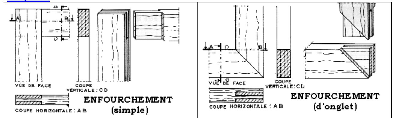
Pour l'assemblage des portes, j'ai préféré l'enfourchement. Vous avez le choix entre l'enfourchement simple ou d'onglet. Si la largeur des montants et traverses vous semble trop importante, vous pouvez peut être la diminuer (attention à recalculer la largeur du panneau de portes).
