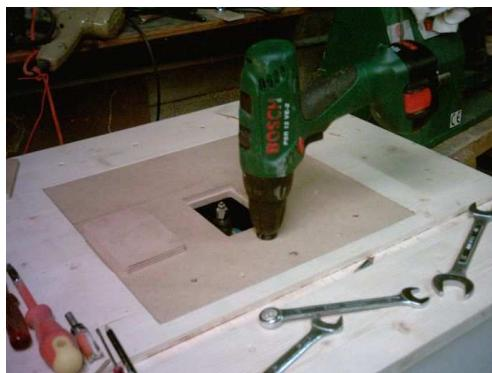
Ce système est conçu pour une défonceuse avec collier de 43mm.
