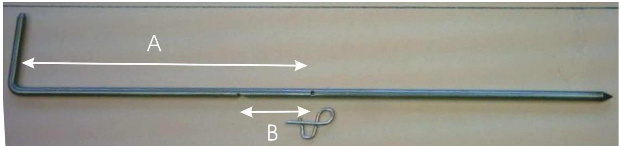
Dans la tige de remontée rapide on percera un trou de 2mm (pour le passage de la goupille) à la distance **A** égale à la distance comprise entre la surface supérieure de la table et le dessous de la traverse 2 quand le chariot est descendu au maximum + 3 ou 4 cm.
