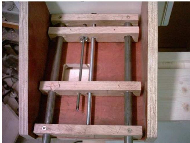
Voici l'ensemble de la mécanique, le chariot étant enlevé. On aperçoit les trous de fixation du chariot dans les deux traverses du centre.
