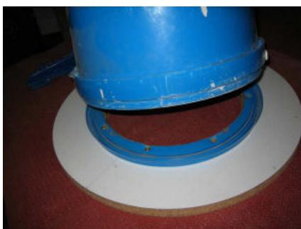
Emboîtez le seau sur son couvercle, et posez le tout à l'envers sur la corbeille. Il reste plus qu'à brancher votre aspirateur sur le tuyau vertical et votre outillage sur le coté. La dépression ainsi créée, centrifugera les copeaux qui resteront emprisonnés dans la corbeille.
