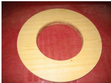
Sur le même principe, découpez dans le panneau de mélaminé un cercle dont le diamètre extérieur est égal au diamètre extérieur de la corbeille. Evider ce cercle en son centre, au même diamètre intérieur que l'entretoise. Nous appellerons cette pièce, le capot.
