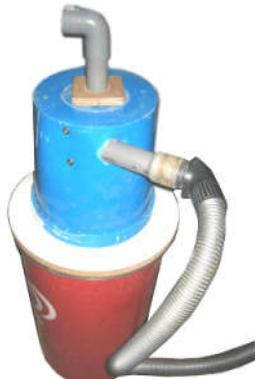
Une des plus grandes contraintes lorsque l'on travaille le bois, est celle liée à l'évacuation de la sciure et des copeaux (sic...).
