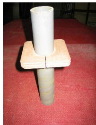
Emmanchez le second tube sur le fond du seau, et fixez la bride par l'intérieur, de façon à le laisser dépasser d'environ 15cm.
