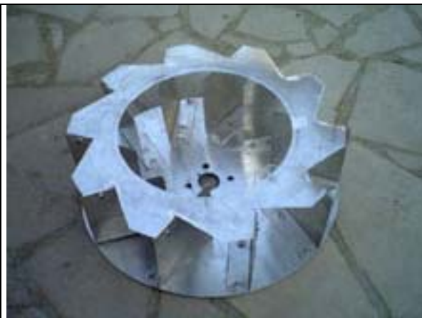
Fig.6 - La turbine de l'aspirateur
