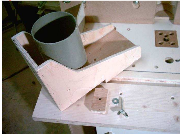
Le chariot avec son système de blocage
