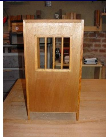
Dans la plaque de CP10 de 400 sur 220, découper un rectangle de 150 sur 100. Border l'intérieur de ce rectangle avec du carrelet de 10. Prévoir les trous et mettre des barreaux (tourillon). Mettre du carrelet de 10 sur 10 sur chaque côté (hauteur de 460). Ce carrelet dépasse de 10 mm en haut.
