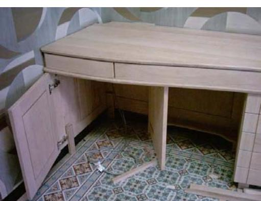
Sous les réglettes de prises de courant, une découpe a été faite dans la tablette et une planche a été appliquée par en dessous pour d'augmenter de 2 cm l'écartement entre les deux plateaux afin d'obtenir la hauteur nécessaire aux fiches et transfo(s) éventuels.
