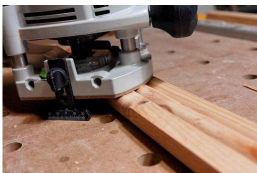
On place tout simplement les carrelets côté à côté. On les maintient en amont afin qu'ils ne remontent pas lors du fraisage. On règle la fraise 1/4 de rond ( $R= 12$  mm) pour l'occasion. Le fait de mettre côté à côté les carrelets permet d'avoir une assise pour la semelle de la défoneuse.
