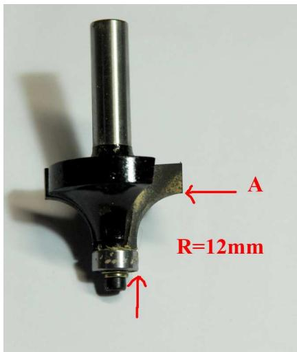
Monter une fraise 1/4 de rond équipée d'un roulement à bille avec un rayon de 12 mm. En effet, avec un rayon de 12 mm, on obtient un diamètre de 24 mm.
