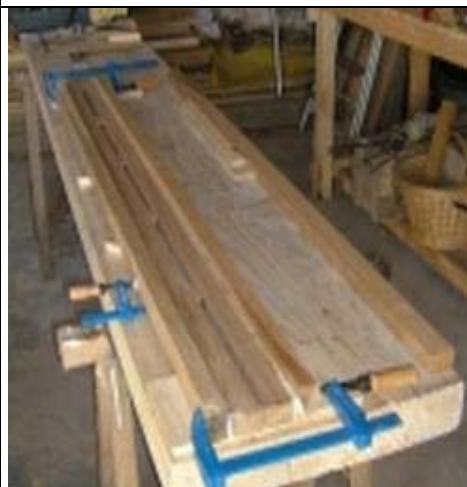
Pour obtenir les deux lisses d'une même balconnière identiques, il suffit de les usiner simultanément :
