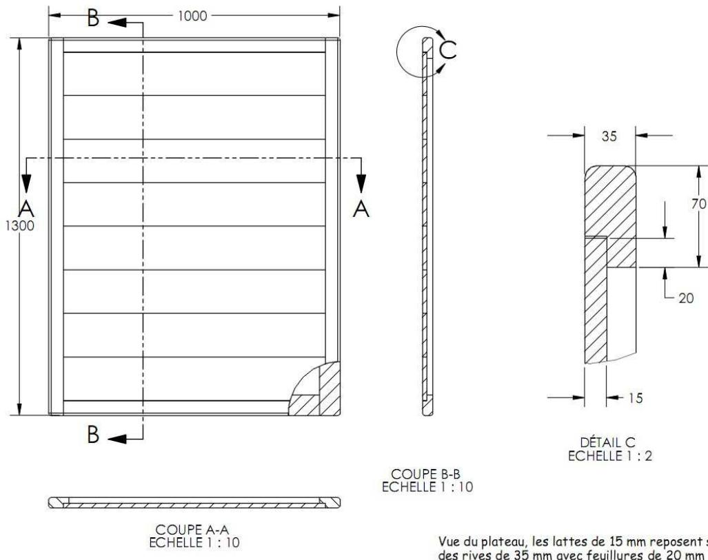
Vue du plateau, les lattes de 15 mm reposent sur des rives de 35 mm avec feuillures de 20 mm
