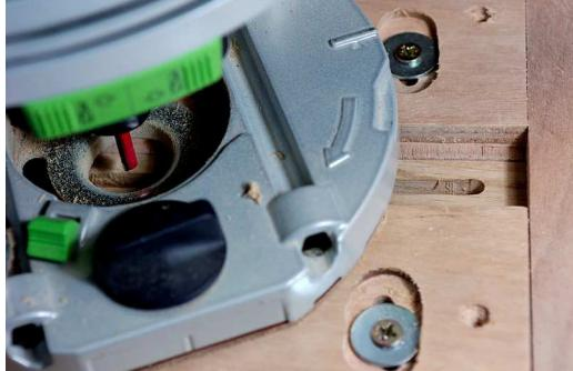
Il suffit s'insérer le morceau dans le gabarit, le bloquer et de passer la défonceuse en deux passes. (j'ai cassé une fraise en voulant faire ma rainure d'un seul coup...).
