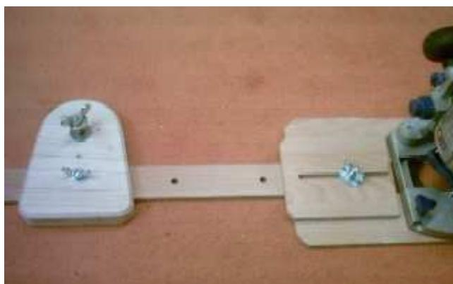
Le centre et la verge qui y est associée s'adaptent sur le compas et remplacent la verge munie d'une pointe.
