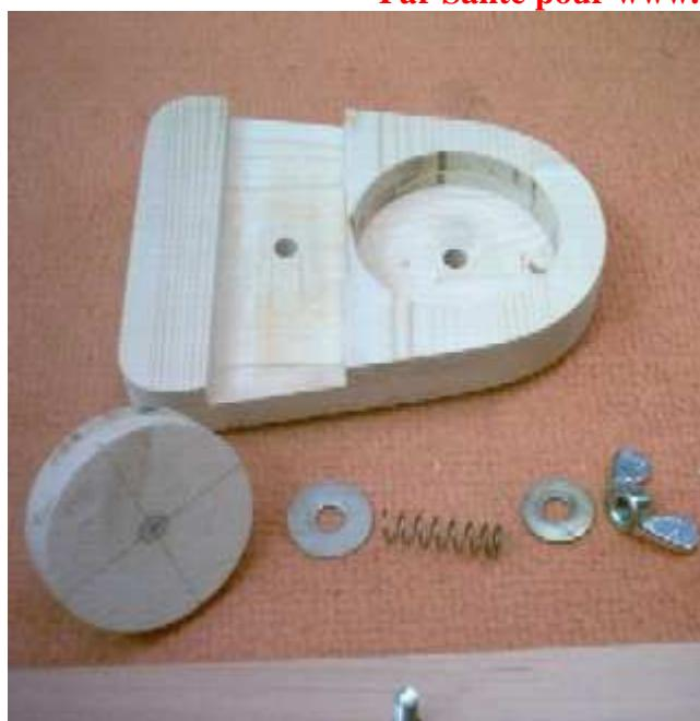
Afin de maintenir un contact permanent entre le pivot collé et la partie mobile j'ai fileté le bout de l'axe pour y fixer un ressort assurant le contact. Je pense que ce ressort n'est pas absolument nécessaire et que l'on pourrait s'en passer mais c'est quand même une sécurité.
